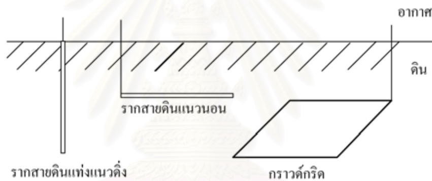
รูปที่ 1.1 โครงสร้างพื้นฐานของกราวด์สายดิน
