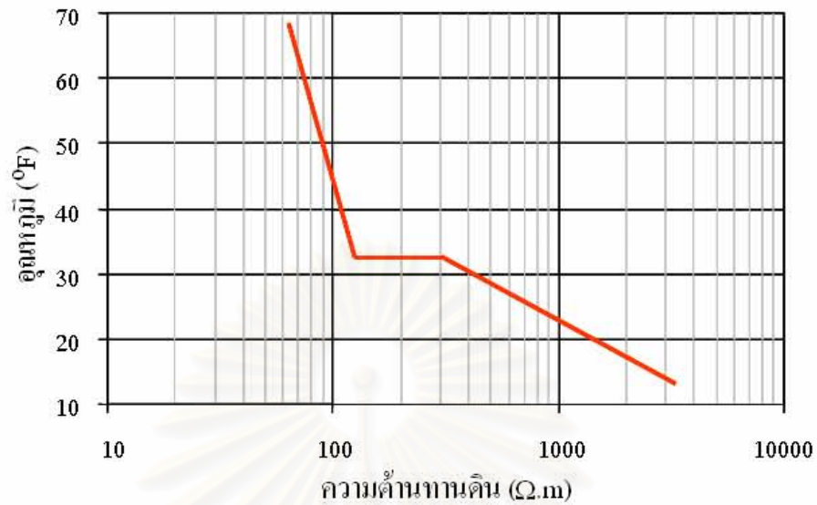
รูปที่ 2.2 ความสัมพันธ์ระหว่างความต้านทานดินกับอุณหภูมิของผิวดิน
