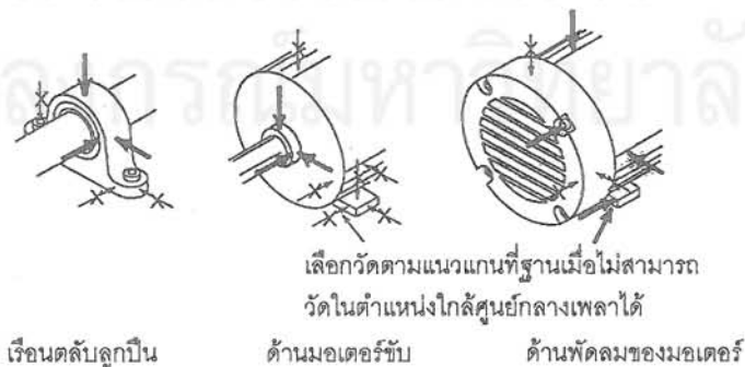
รูปที่ 9.14 ตำแหน่งในการวัดที่เหมาะสมและไม่เหมาะสม
