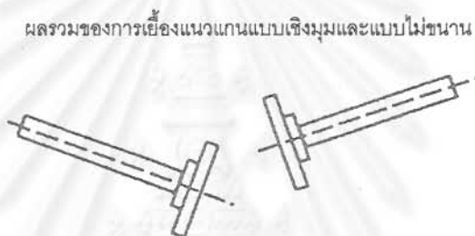
รูปที่ 9.7 ลักษณะของการเยื้องแนวแกนแบบต่าง ๆ
