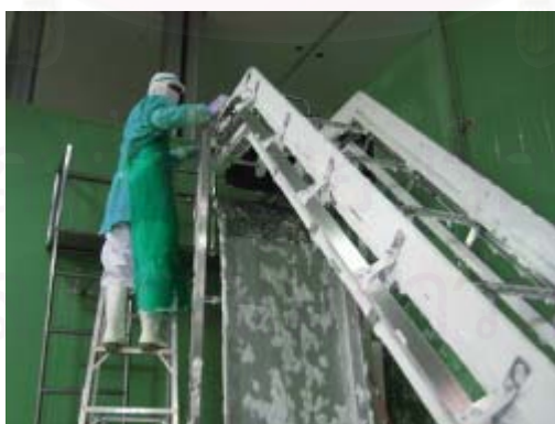
รูปที่ 4.10 การล้างโครงของสายพานลำเลียงผลิตภัณฑ์ออกจากเครื่องแช่เย็น
