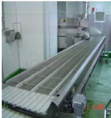
รูปที่ 4.3 สายพานลำเลียงผลิตภัณฑ์จากเครื่องให้ความร้อนไปยังเครื่องแช่เย็น
