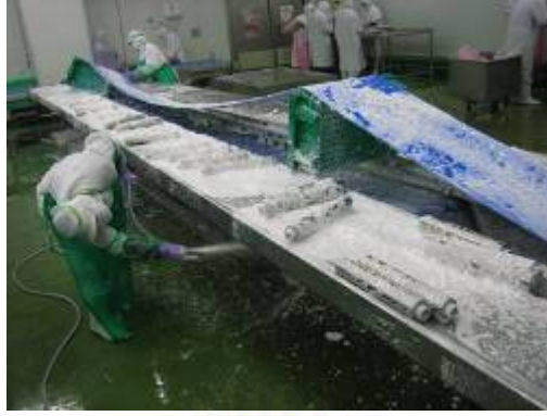
รูปที่ 4.17 การถอดแกนหมุนสายพานลำเลียงไก่เพื่อให้พนักงานหัน
