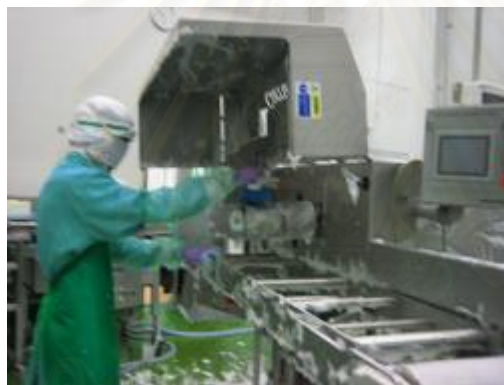
รูปที่ 4.14 การล้างทำความสะอาดส่วนของตัวเครื่องหั่นไม้
