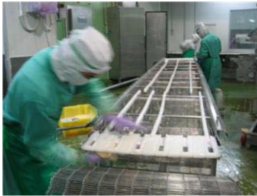
รูปที่ 4.4 สายพานลำเลียงขณะล้างทำความสะอาดโดยการถอดสายพานเส้นลวดออก
