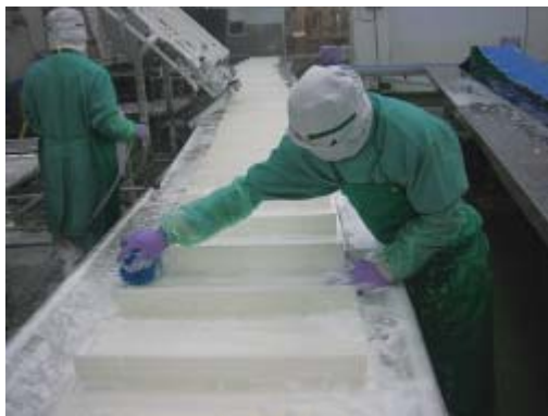
รูปที่ 4.8 การถอดล้างสายพานลำเลียงผลิตภัณฑ์ออกจากเครื่องแช่เย็น
