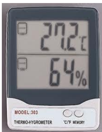
ภาพที่ 3.6 เครื่องวัดอุณหภูมิและความชื้นสัมพัทธ์ Model 303
