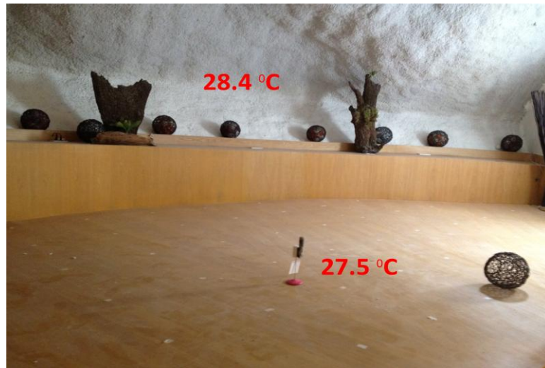
ภาพที่ 4.3 แสดงการวัดอุณหภูมิ ความชื้น โดยใช้เครื่องวัดอัตโนมัติ Data Logger เพื่อวัดค่าอุณหภูมิและความชื้นห้องนวดไทยขณะปิดเครื่องปรับอากาศ
