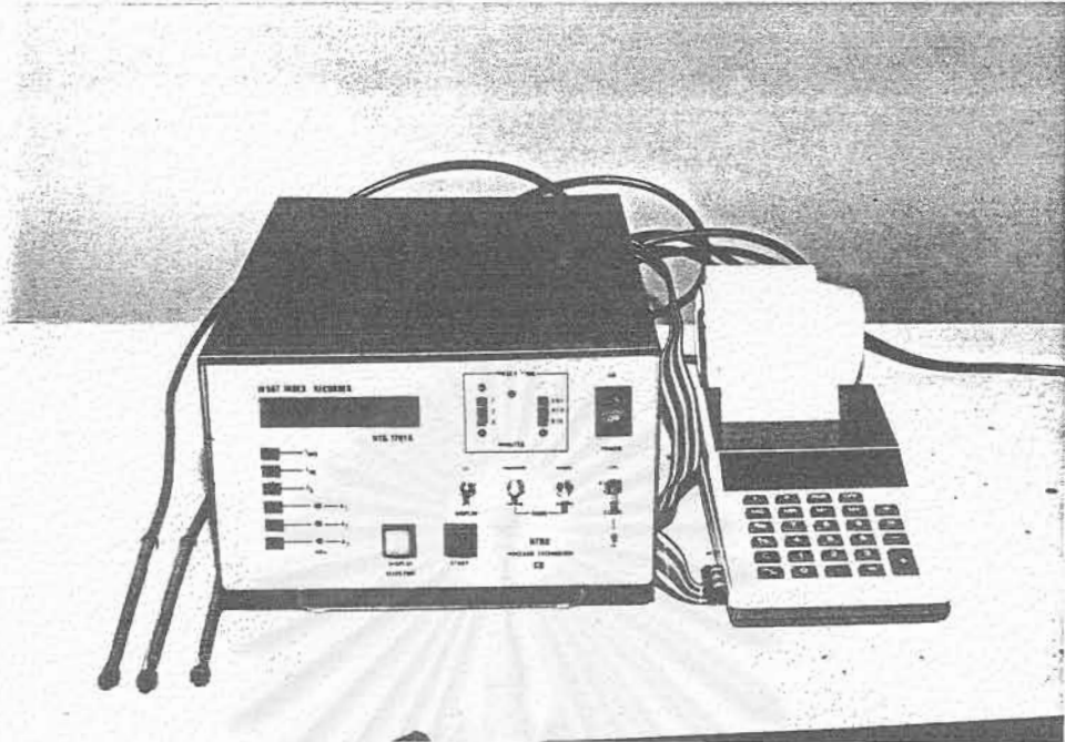
รูปที่ 4.4 เครื่องวัดและบันทึกดรรชนีอุณหภูมิแบบ WBGT รุ่น NT 1701 A
