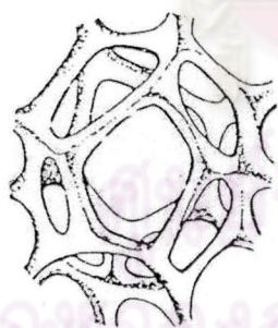
ก) โครงสร้างเซลล์แบบเปิด
