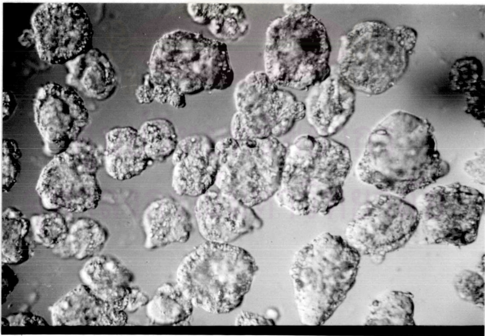
รูปที่ 19 ลักษณะอนุภาคอาหารที่ได้จากการอบแห้งด้วยเครื่องอบแห้งแบบพ่นกระจาย จากกล้องจุลทรรศน์ กำลังขยาย 100 เท่า
