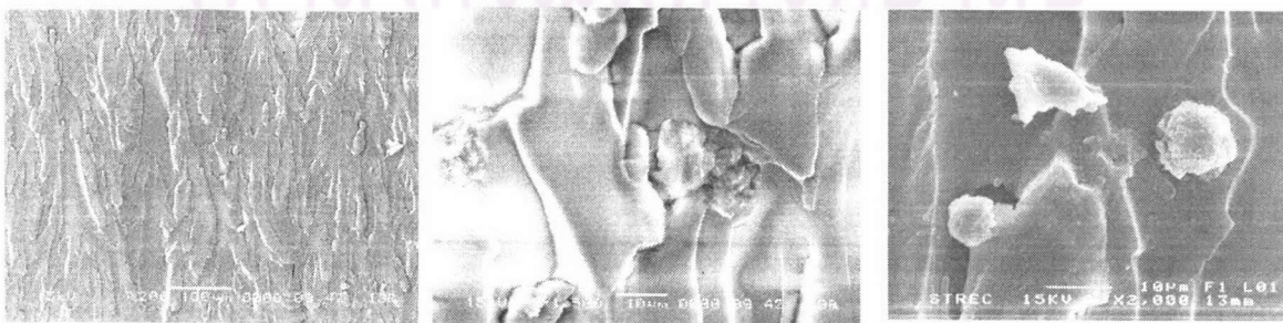
รูปที่ จ-16 สัณฐานวิทยาของพื้นผิวที่รอยแตกหักของพอลิเมอร์ผสมระหว่าง อีพอกซีเรซินกับ ENR 40 7 phr
