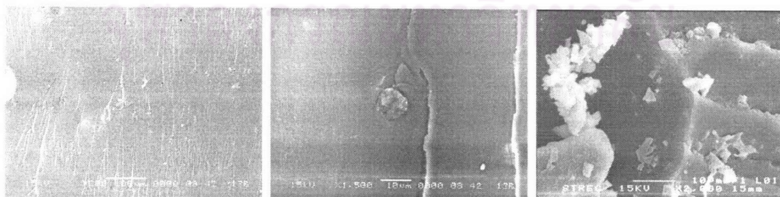
รูปที่ ๑-12 สัณฐานวิทยาของพื้นผิวที่รอยแตกหักของพอลิเมอร์ผสมระหว่าง อิพอกซีเรซินกับ ENR 25 7 phr
