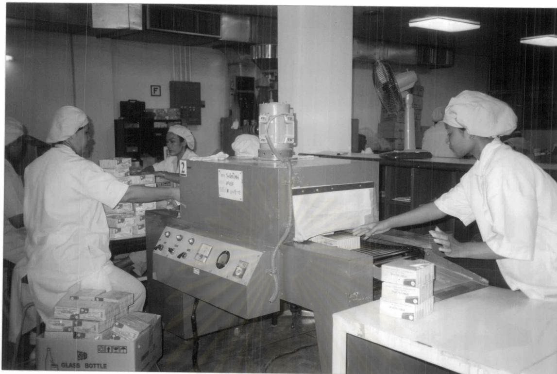
รูปที่ 4.21 ภาพแสดงการห่อฟิล์มเมซินโดยผ่านเครื่อง Shrink Tunnel
