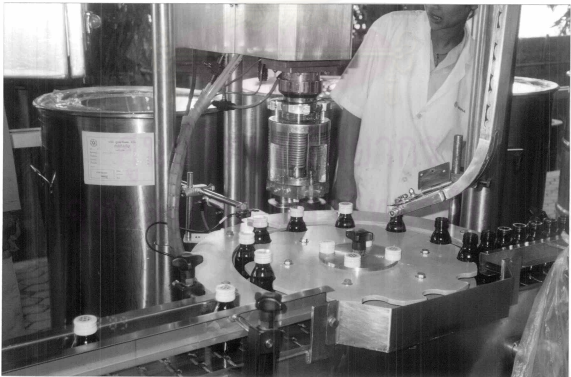
รูปที่ 4.16 ภาพแสดงการปิดขวดยาด้วยเครื่องรีดเกลียว
