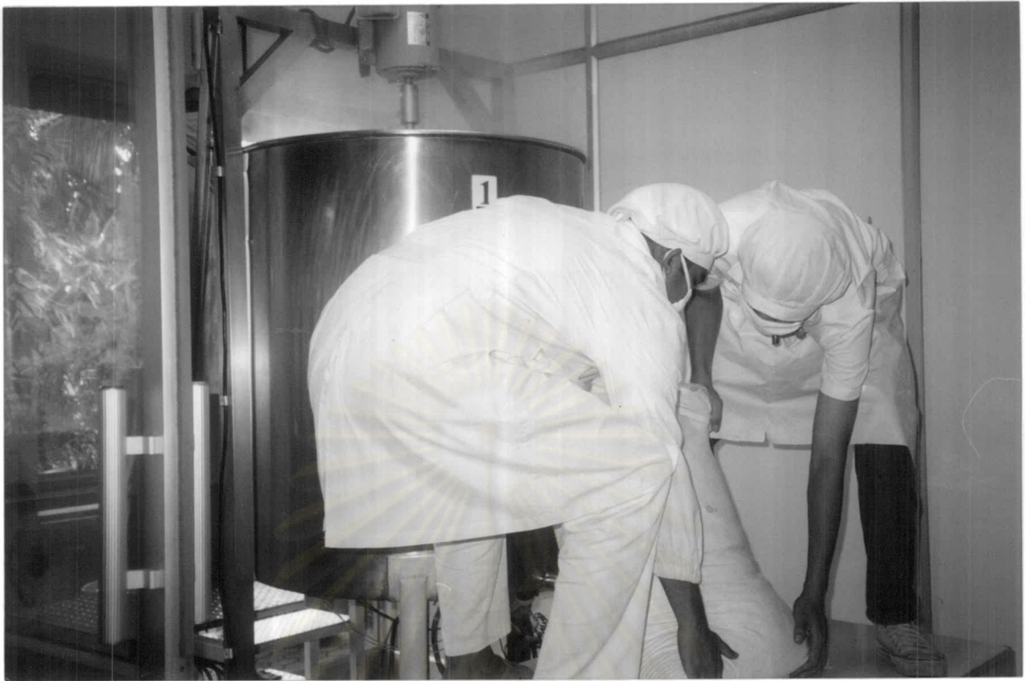
รูปที่ 4.3 ภาพแสดงขั้นตอนการยกน้ำตาลเทก่อนปรับปรุง
