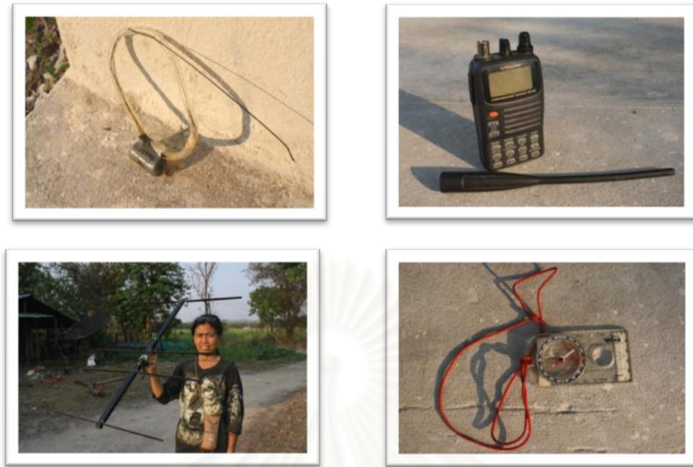
ภาพที่ 4.2 แสดงอุปกรณ์ที่ใช้ในการศึกษาพื้นที่การอาณาเขตครอบครองอยู่ของไก่ป่าตุ้มหูแดง บนซ้าย: เครื่องส่งสัญญาณวิทยุ บนขวา: เครื่องรับส่งสัญญาณวิทยุ ล่างซ้าย: เสาอากาศแบบ yagi ล่างขวา: เซ็มทิศ
