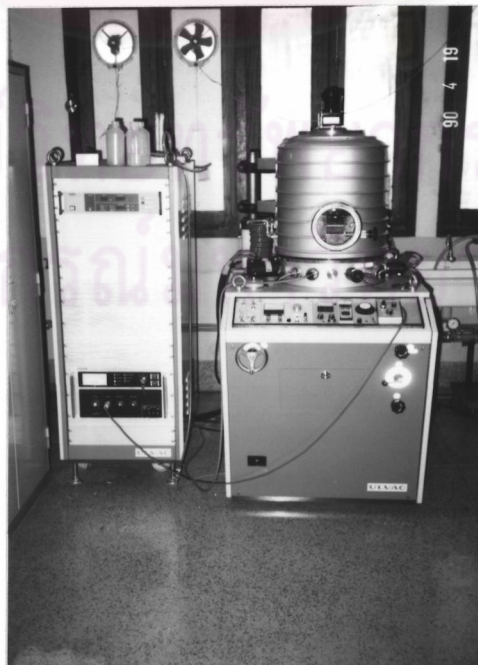
รูปที่ 5.4 ระบบ electron beam evaporator ที่ใช้สร้างขั้วไฟฟ้า
