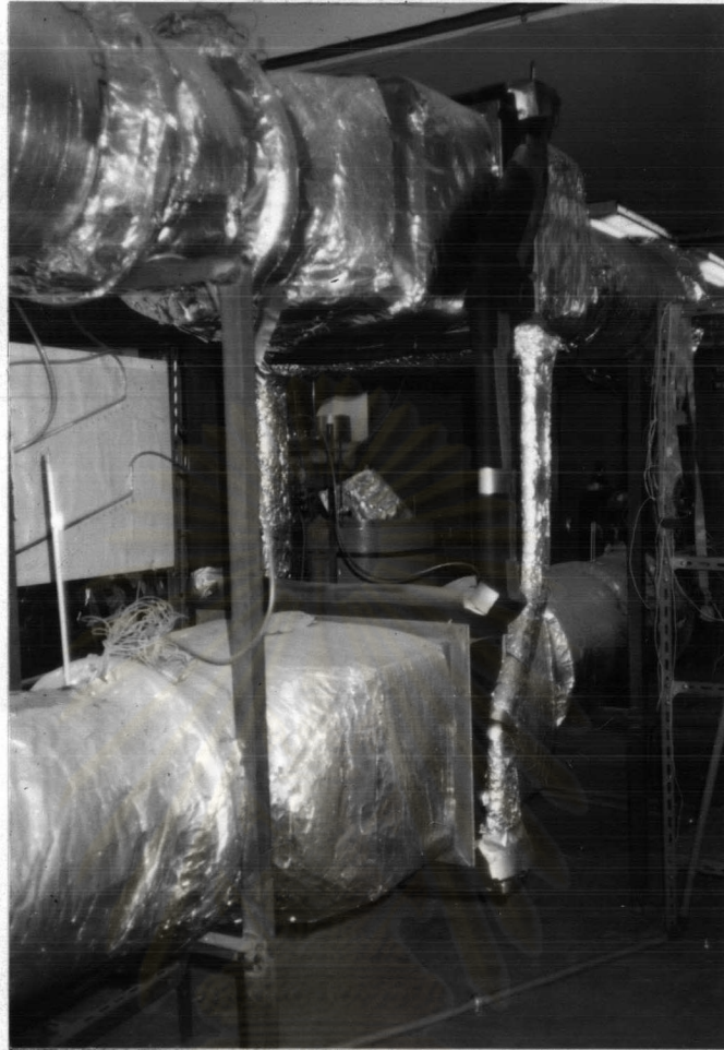
รูปที่ 3.4 ภาพถ่ายเครื่องแลกเปลี่ยนความร้อนแบบ คอยล์-ลูบ เทอร์โมไซฟอน ที่ประกอบเสร็จและพร้อมทดสอบสมรรถนะ
