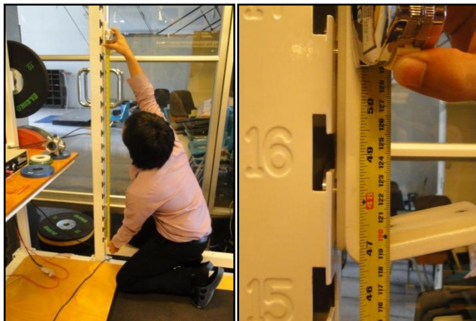
ภาพที่ 22 วัดระยะระหว่างตำแหน่งหมายเลข 1 และ 16 ด้วยตลับเมตร(ผ่านการสอบเทียบ) ได้ 1.2 เมตร
