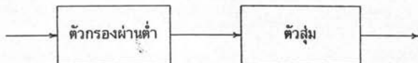
รูปที่ 2.2 การกรองผ่านต่ำ และการสุ่มเพื่อลดจำนวนจุด
