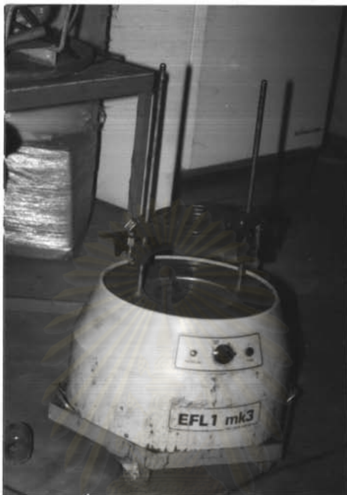
รูปที่ 4.1(ต่อ) เครื่องมือและอุปกรณ์ที่ใช้ผลิตน้ำมันกัดด้วย ZnCl_2 เครื่องเขย่าแรง
