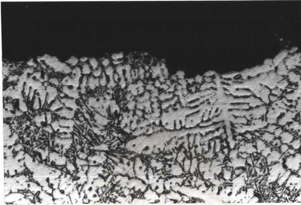
รูปที่ 5.23 โครงสร้างจุลภาคได้ผิวการแตกหักของอะลูมิเนียมผสมหล่อ 10% ซิลิกอน
