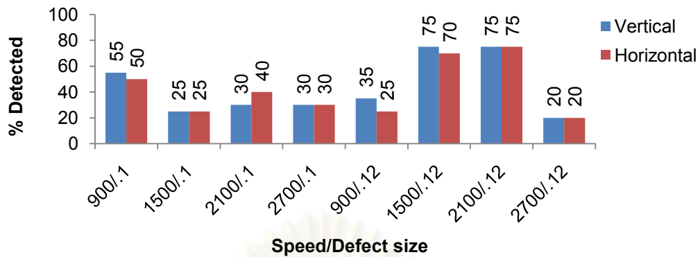
รูปที่ 5-139 ผลการตรวจจับความเสียหายที่เม็ดลูกปืนภายใต้ภาระในแนวรัศมี 830N เมื่อนำสัญญาณ 2 ชุดมาต่อกัน
