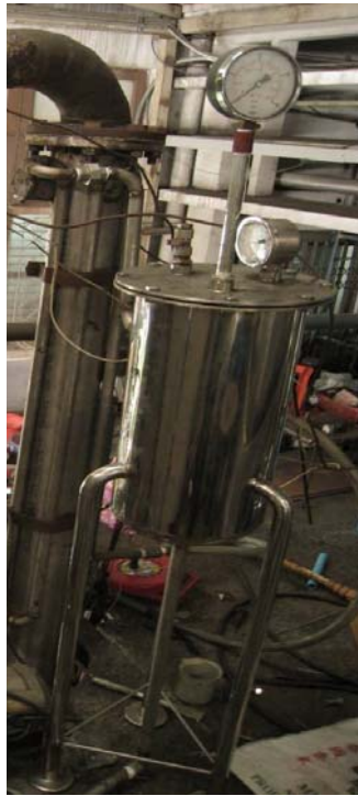
ภาพที่ 3.21 ส่วนเก็บไอน้ำ (Steam Space)
