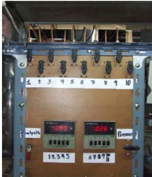
ภาพที่ 3.14 หน้าจอแสดงอุณหภูมิและวาล์วสำหรับดึงแก๊สออกจากระบบ
