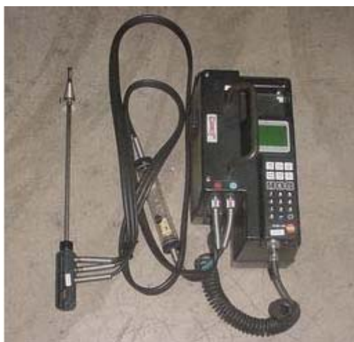
ภาพที่ 3.16 เครื่องวัดฟลูแก๊ส (Flue gas Analyzer)
