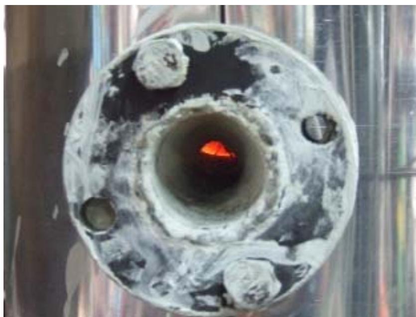
ภาพที่ 3.9 กระจกสำหรับดูภายในห้องเผาไหม้
