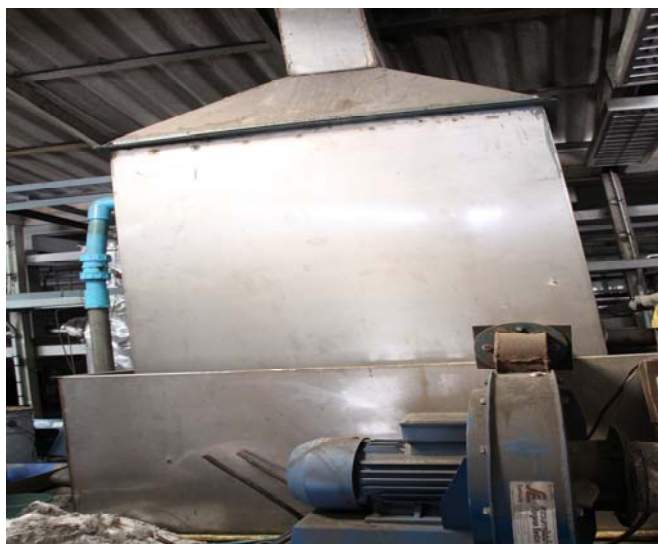
ภาพที่ 3.2 เตาเผาฟลูอิดไชน์เบดแบบหมุนเวียนที่ใช้ในงานวิจัย
