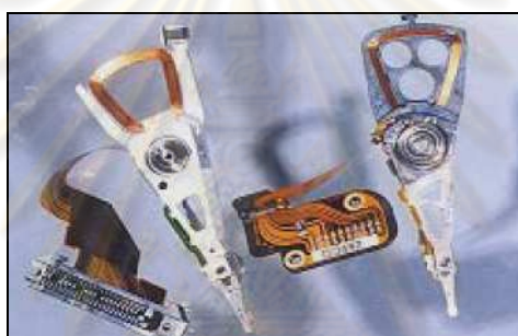
รูปที่ 1.2 ชุดประกอบหัวอ่านเขียนสำเร็จ (Head Stack Assembly; HSA)
