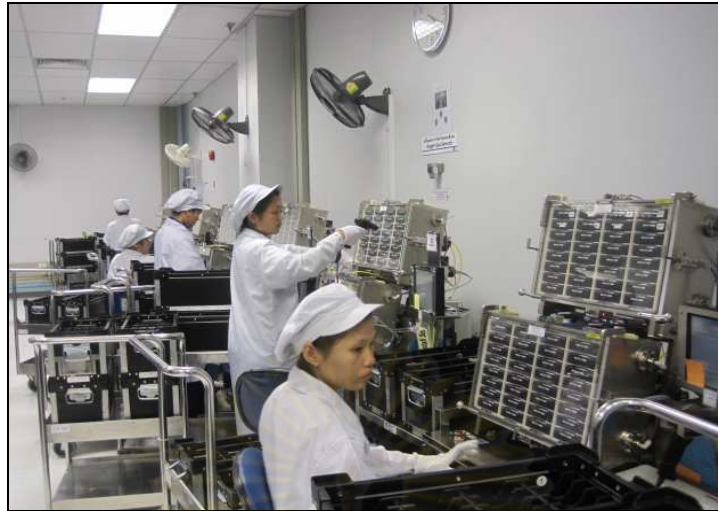
รูปที่ 3.12 กระบวนการอัดก๊าซฮีเลียม (Helium charge) ของโรงงานกรณีศึกษา
