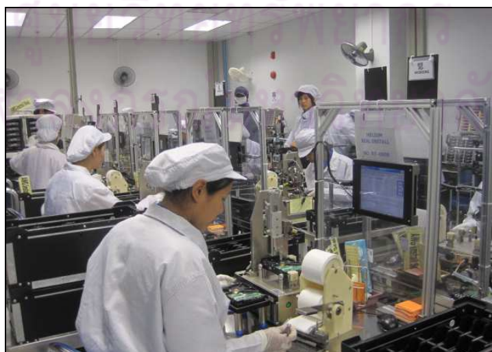
รูปที่ 3.14 กระบวนการติดตั้งซีล (Seal install) ของโรงงานกรณีศึกษา
