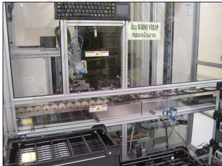
รูปที่ 3.3 ฮาร์ดดิสก์ไดร์ฟจะเลื่อนไปบนสายพานหน้าเครื่องเพื่อเข้าสู่เครื่องทดสอบเอ็กคาร์ลิเบอร์
