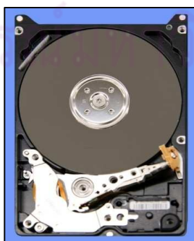
รูปที่ 1.3 ฮาร์ดดิสก์ไดรฟ์สำหรับคอมพิวเตอร์ส่วนบุคคล (2.5" Hard disk drive)
