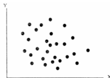
รูปที่ 2.24 การเพิ่มหรือลดค่าของ X อาจทำให้ค่า Y เป็นไปได้ทั้งเพิ่มและลด
