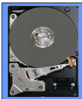
รูปที่ 1.4 ฮาร์ดดิสก์ไดรฟ์สำหรับคอมพิวเตอร์ตั้งโต๊ะ (3.5" Hard disk drive)
