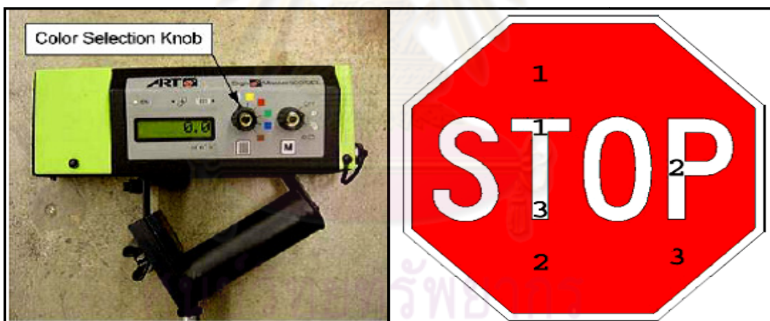
รูปที่ 2.22 ART Sign Master 920 SEL วัดค่าการสะท้อนแสงแบบพกพาและจุดวัดค่าของป้ายหยุด
