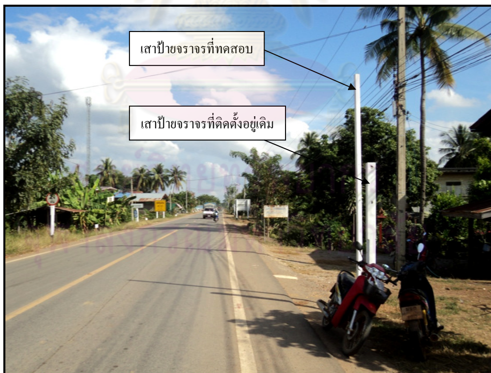
รูปที่ 3.9 เสาป้ายจราจรที่ทำการติดตั้งใหม่เพื่อการทดสอบงานวิจัย
