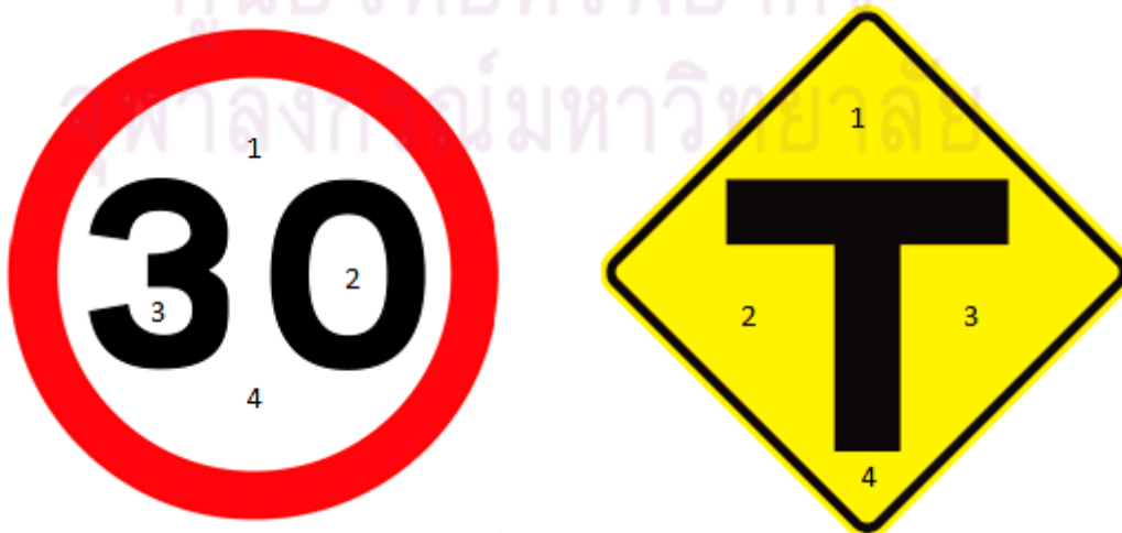
รูปที่ 3.13 การสุ่มจุดการวัดค่าสัมประสิทธิ์การสะท้อนแสงของป้ายจราจร 4 จุดในแต่ละประเภทสี
