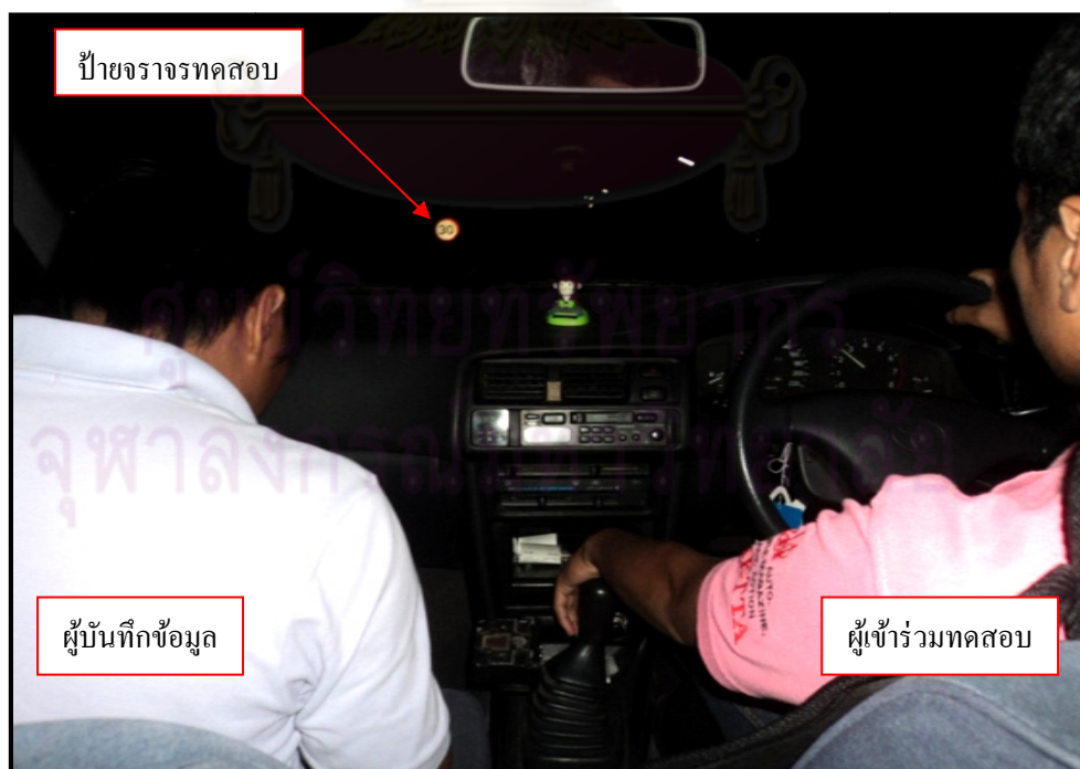
รูปที่ 3.26 การทดสอบขับขึ้นของผู้เข้าร่วมเพื่อประเมินระยะพบและมองเห็นป้ายจราจร
