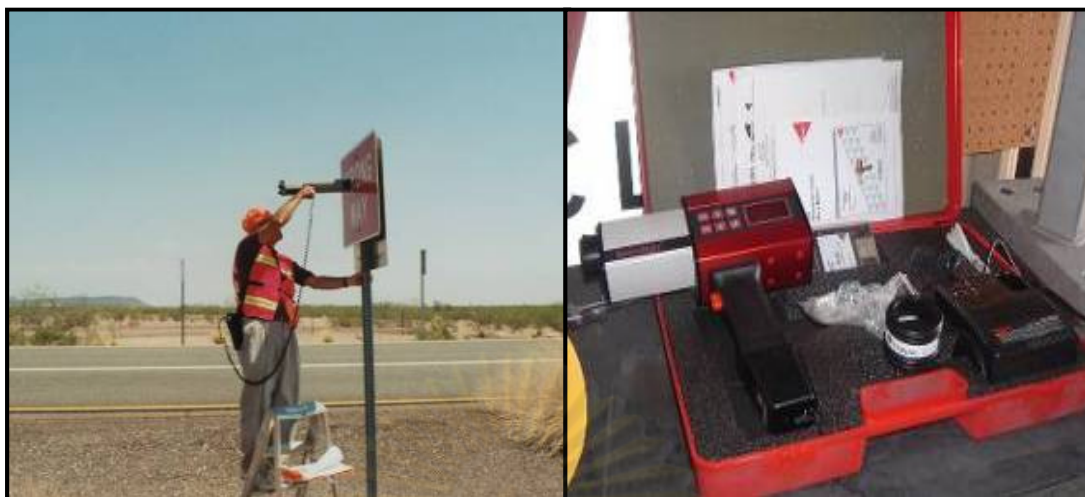
รูปที่ 2.16 การวัดค่าสัมประสิทธิ์การสะท้อนแสงของป้ายจราจรในภาคสนาม (FHWA, 2008)
