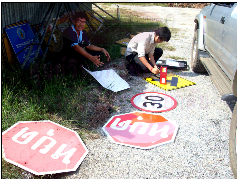
รูปที่ 3.16 การทดสอบค่าสัมประสิทธิ์การสะท้อนแสงของป้ายจราจรแต่ละประเภท
