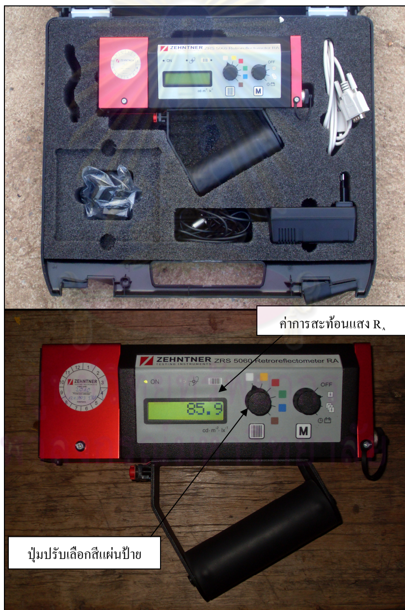
รูปที่ 3.14 เครื่องมือใช้วัดค่าสัมประสิทธิ์การสะท้อนแสงของป้ายจราจรในภาคสนาม
