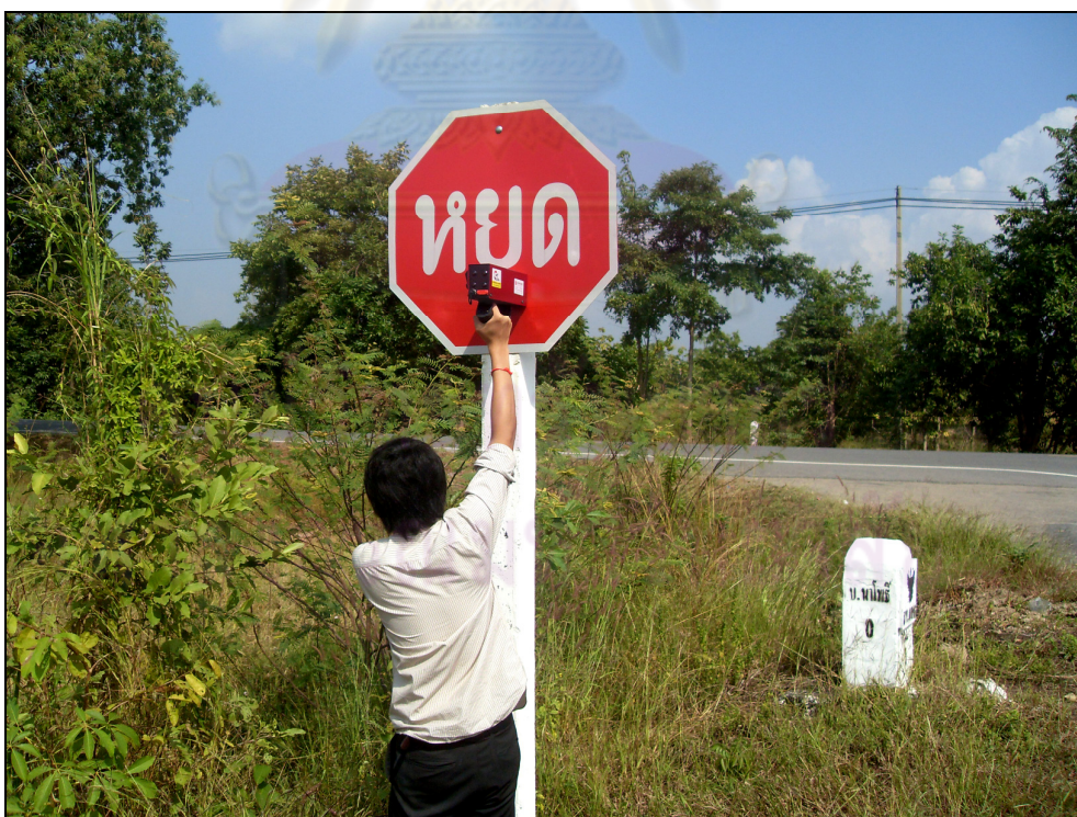
รูปที่ 3.18 การทดสอบค่าสัมประสิทธิ์การสะท้อนแสงของป้ายจราจรบนเส้นทาง
