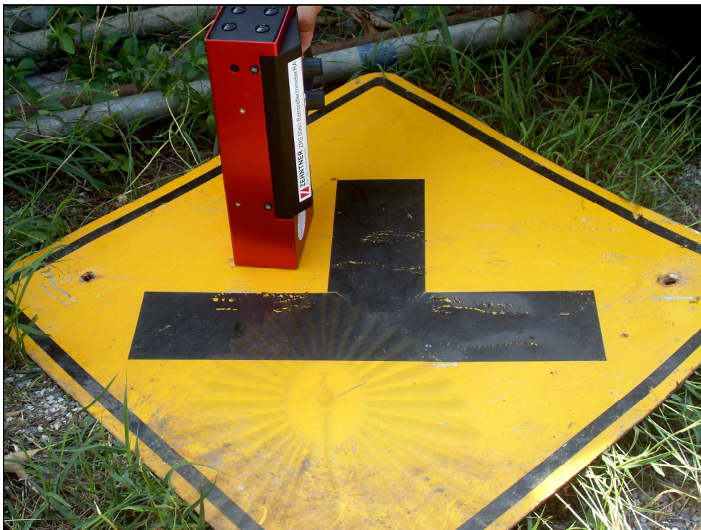
รูปที่ 3.17 การทดสอบค่าสัมประสิทธิ์การสะท้อนแสงของป้ายจราจรเก่า
