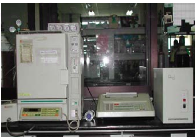
รูปที่ 3.4 เครื่องแก๊สโครมาโทกราฟ
