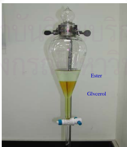
รูปที่ 3.3 ลักษณะการแยกชั้นระหว่างเอสเทอร์และกลีเซอรอล
