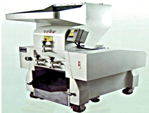
ภาพที่ ง-9 เครื่องรีไซเคิลพลาสติกขนาดเล็ก 10 แรงม้า (บริษัทคัดแยกขยะเพื่อรีไซเคิล วงษ์พาณิชย์จำกัด สาขาวังน้อย)
