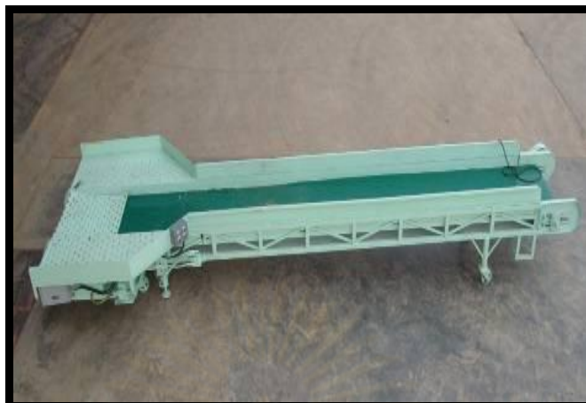
ภาพที่ ง-3 สายพานแม่เหล็กใช้สำหรับตรวจจับโลหะชนิดเหล็กและคัดแยกสิ่งเจือปน ที่มาจากพลาสติก ดิน ไม้ ถูพลาสติก หรือวัสดุชนิดอื่น (บริษัทคัดแยกขยะ เพื่อรีไซเคิล วงษ์พาณิชย์จำกัด สาขาวังน้อย)
