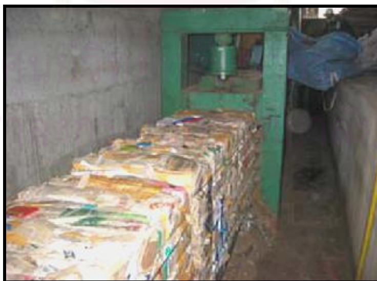
ภาพที่ 4-6 กระบวนการแปรรูปสินค้าประเภทกระดาษไปเข้าเครื่องอัดไฮดรอลิค เพื่อทำ
