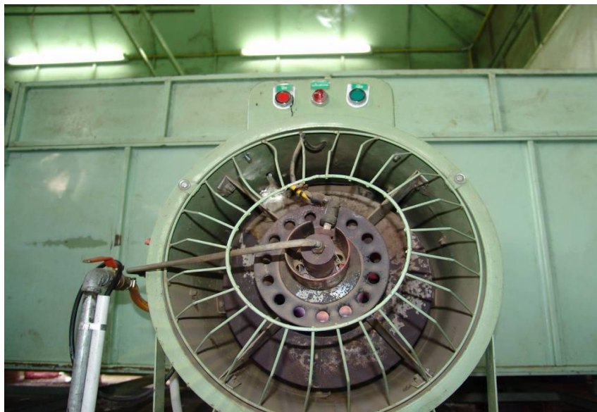
ภาพที่ ง-1 เครื่องอบไล่ความชื้น (บริษัทคัดแยกขยะเพื่อรีไซเคิล วงษ์พาณิชย์จำกัด สาขา วงแหวนบางปะอิน)
