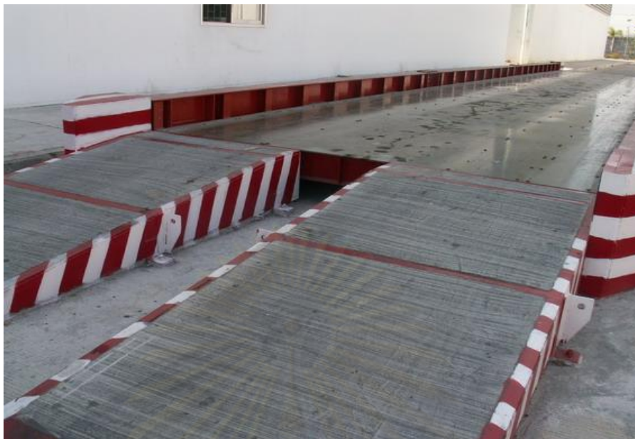
ภาพที่ ง-21 ตาชั่งใหญ่ขนาดมาตรฐานยาว 18 เมตร 50-60 ตัน (บริษัทคัดแยกขยะเพื่อรีไซเคิล วงษ์พาณิชย์จำกัด สาขาวงแหวนบางปะอิน)
