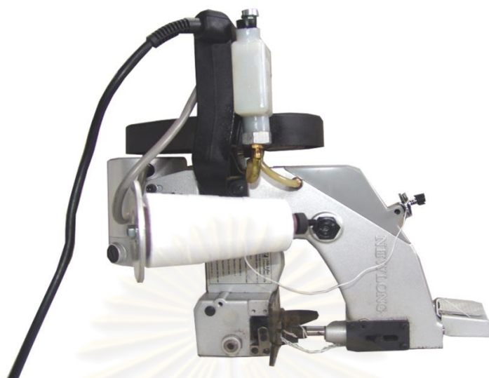
ภาพที่ ง-13 เครื่องเย็บกระสอบ (บริษัทคัดแยกขยะเพื่อรีไซเคิล วงษ์พาณิชย์จำกัด สาขา วังน้อย)
