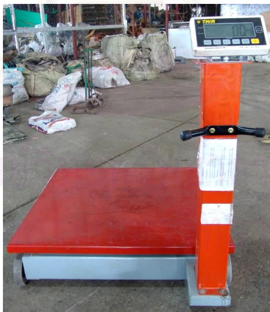
ภาพที่ ง-20 เครื่องชั่งดิจิตอลขนาด 2 ตัน (บริษัทคัดแยกขยะเพื่อรีไซเคิล วงษ์พาณิชย์จำกัด สาขาวงแหวนบางปะอิน)
