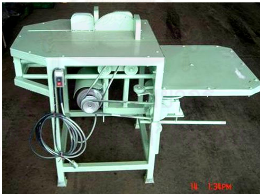
ภาพที่ ง-2 เครื่องตัดฝาฟอลย์ (บริษัทคัดแยกขยะเพื่อรีไซเคิล วงษ์พาณิชย์จำกัด สาขา วงแหวนบางปะอิน)
