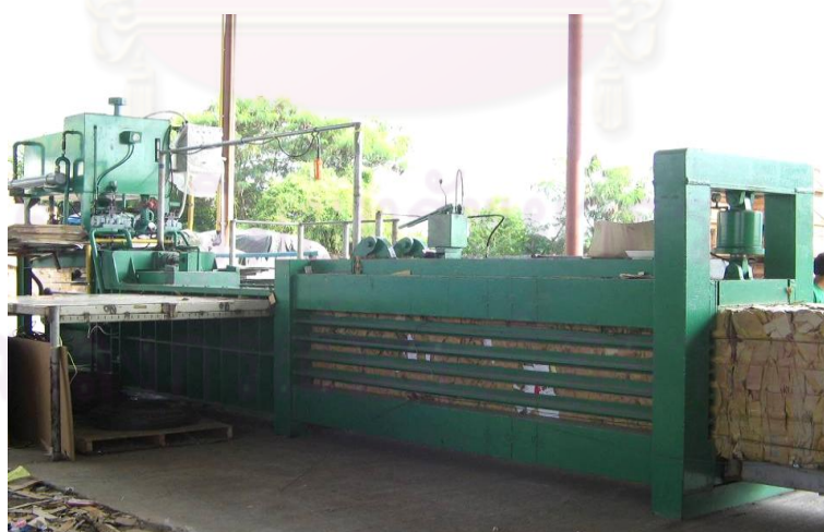
ภาพที่ ง-6 เครื่องอัดเอนกประสงค์ขนาดใหญ่ (บริษัทคัดแยกขยะเพื่อรีไซเคิล วงษ์พาณิชย์ จำกัด สาขาวังน้อย)
