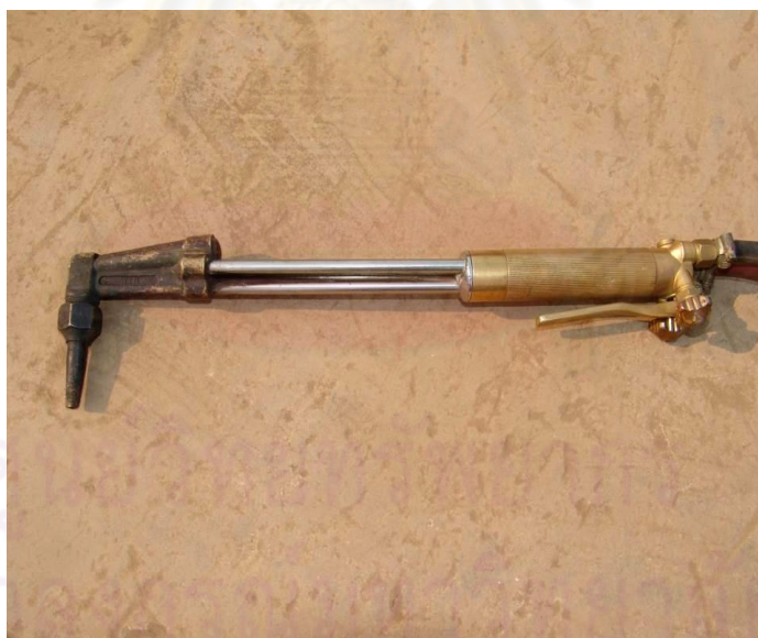
ภาพที่ ง-16 หัวตัดเหล็ก (บริษัทคัดแยกขยะเพื่อรีไซเคิล วงษ์พาณิชย์จำกัด สาขา วังน้อย)
