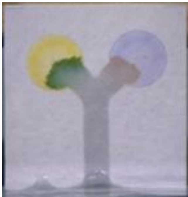
ภาพที่ 4.26 แล็บบนชิปต้นแบบหลังจากการทดสอบสารละลายตัวอย่างเมื่อเวลาผ่านไป 7 นาที
