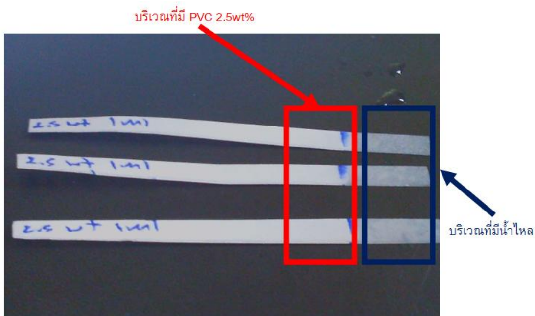
ภาพที่ 3.25 การทดสอบที่ความเข้มข้นของ PVC 2.5wt%, 1 ไมโครลิตร
