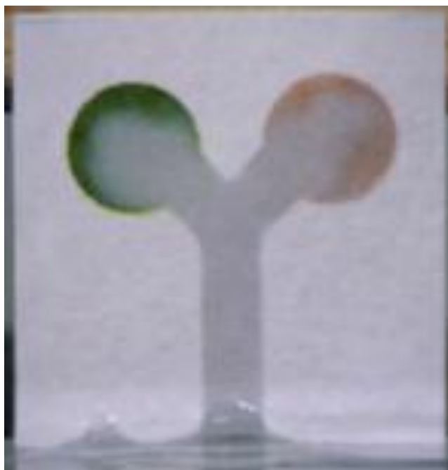
ภาพที่ 4.27 แล็บบนชิปต้นแบบหลังจากการทดสอบสารละลายตัวอย่างเมื่อเวลาผ่านไป 32 นาที
