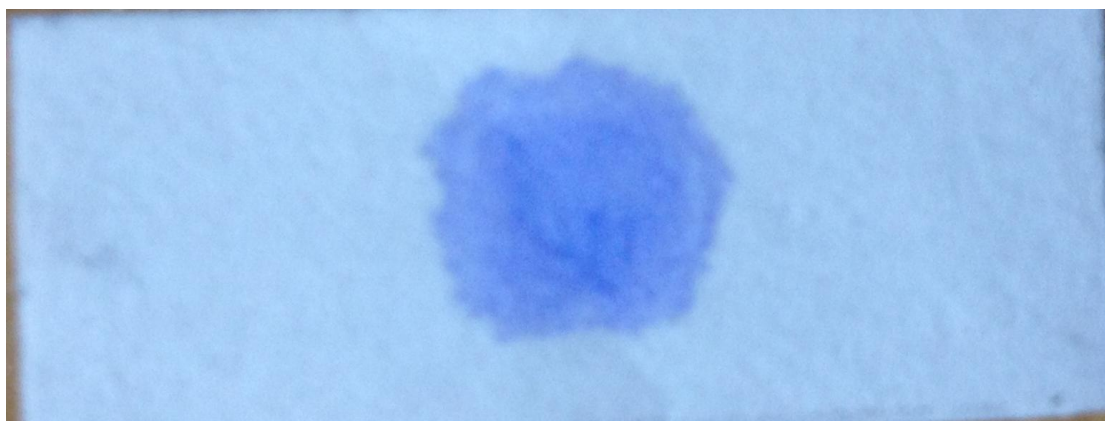
ภาพที่ 4.4 การทดสอบความเข้มข้นของสารละลายโพลิเมอร์ Polystyrene ที่ความเข้มข้น 1.0% โดย มวลต่อปริมาตร
