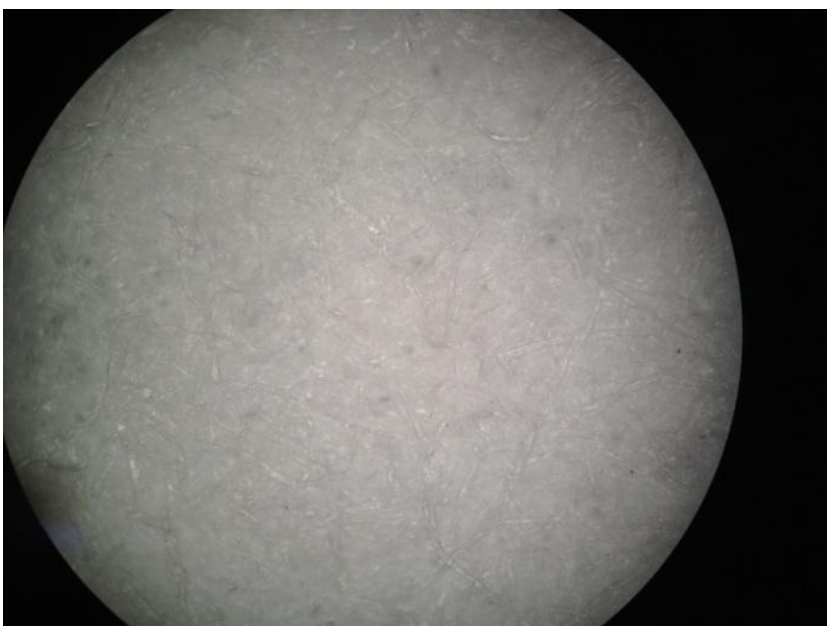
ภาพที่ 4.19 ภาพกำลังขยาย 100 เท่าของกระดาษกรอง Whatman grade 1 ผ่านการเคลือบ Polystyrene ที่ความเข้มข้น 3.0%
