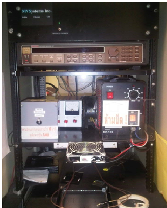
รูปที่ 3.4 เครื่องทดสอบประสิทธิภาพเซลล์พลังงานแสงอาทิตย์
