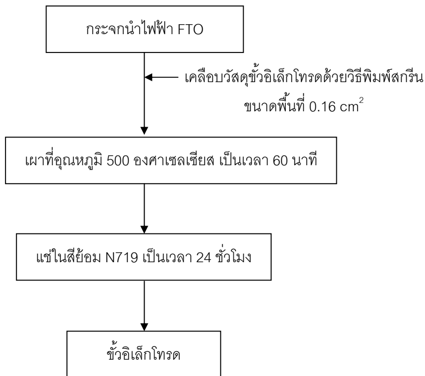
รูปที่ 3.11 แผนภาพแสดงขั้นตอนการเตรียมขั้วอิเล็กโทรด
