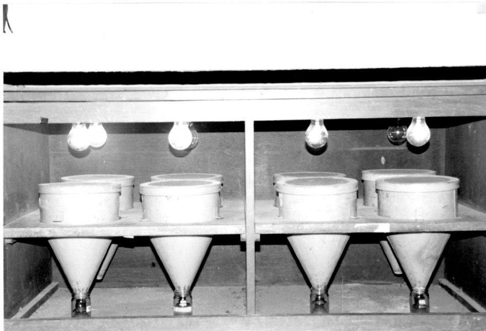
รูปที่ 3.7 การสกัดสัตว์ในดินขนาดกลางโดยใช้ Tullgren funnel
