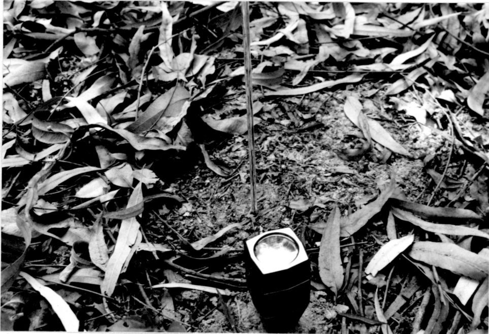
รูปที่ 3.4 การวัดอุณหภูมิดินโดยใช้ thermometer และการวัด pH ของดินโดยใช้ soil tester
