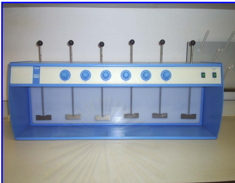
รูปที่ ก-3 เครื่องมือที่ใช้ทดลองการดูดซับที่ย้อมแอสิด กรีน 25 ของไคโตซาน(เครื่องจาร์เทส)
