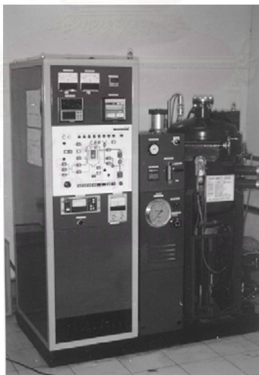
รูปที่ 3.6 เตาควบคุมบรรยากาศ รุ่น High-Multi 500 FV PHP-R-5 FRET-25
