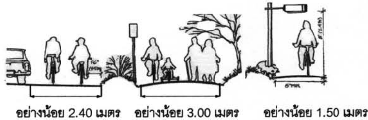
รูปที่ 2.7 แสดงความกว้างของเส้นทางตามลักษณะผู้ใช้ (Charles W. Harris and Nicholas T. Dines, 1988)
