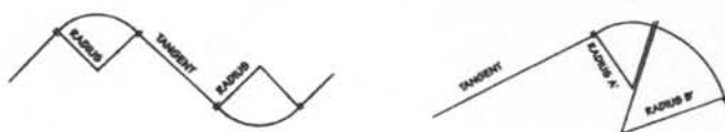
รูปที่ 2.18 แสดงลักษณะโค้งหักกลับและโค้งหักศอก (Kyle D. Brown, 1998)
