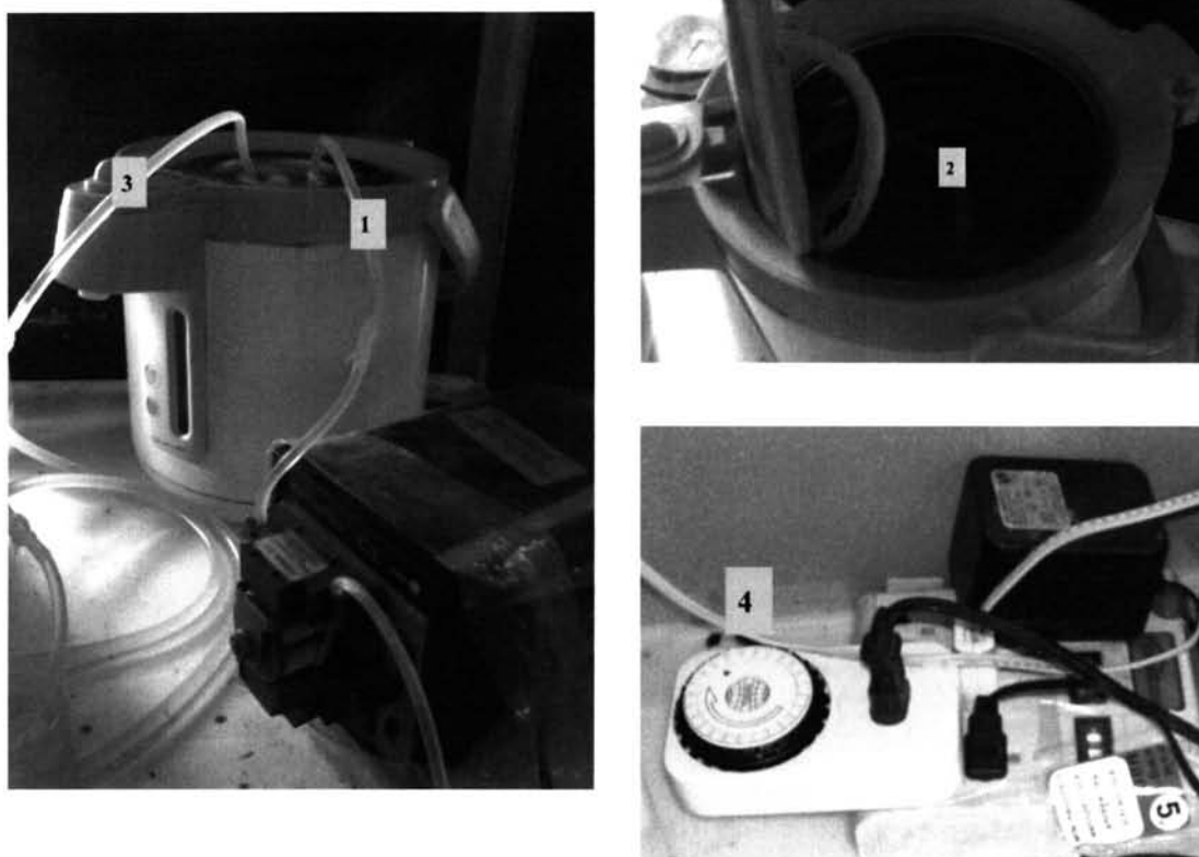
ภาพที่ 3-10 ระบบฆ่าเชื้อของอาหารเพาะเชื้อสำหรับด้วยความร้อนซึ่งคิดแปลงมาจากกาดัมน้ำ (1) สายซิลิโคนที่ต่อมาจากเครื่องสูบน้ำแบบรีดสาย (2) ลักษณะของสายซิลิโคนที่ขด ภายในกาดัมน้ำมีความยาว 100 เซนติเมตร (3) ปลายสายที่ออกมาจากกาดัมน้ำ (4) เครื่องควบคุมเวลา
