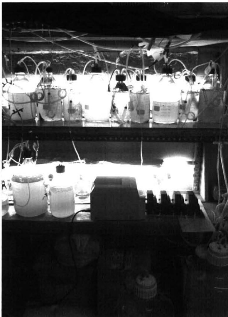
ภาพที่ 3-9 ระบบการเลี้ยงสาหร่าย I. galbana และ โคฟีพอดแบบต่อเนื่องที่สัดส่วนของปริมาตร สาหร่าย I. galbana ต่อโคฟีพอดเท่ากับ 1:2, 1:1 และ 2:1 (จากซ้ายมือ)
