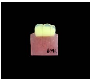
ภาพที่ 24 แสดงชิ้นงานหลังการตัดให้ได้ความหนา 2 มิลลิเมตร
