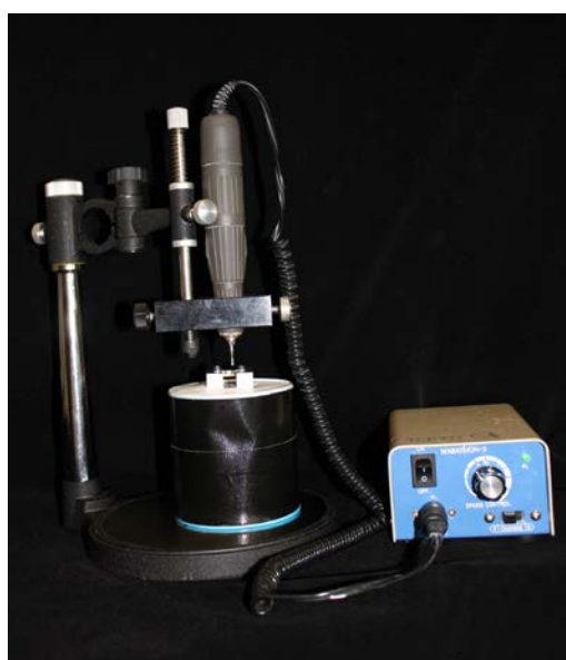
ภาพที่ 28 แสดงเครื่องสำรวจความขนานและไมโครเมตร
