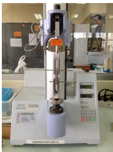
ภาพที่ 34 แสดงเครื่องทดสอบแรงดึงแรงอัด (Shimadzu รุ่น EZ-S, Kyoto, Japan)
