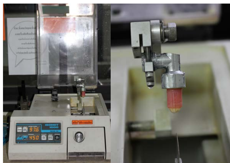
ภาพที่ 23 แสดงการตัดชิ้นงานด้วยเครื่อง Isomet 1000 ตามแนวยาวของฟัน
