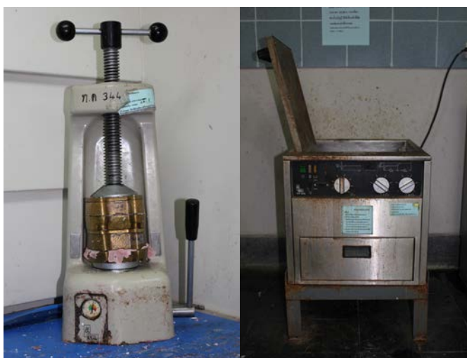
ภาพที่ 20 แสดงเครื่องอัดภาชนะหล่อแบบพินชนิดไฮดรอลิกและเครื่องบ่มอะคริลิก
