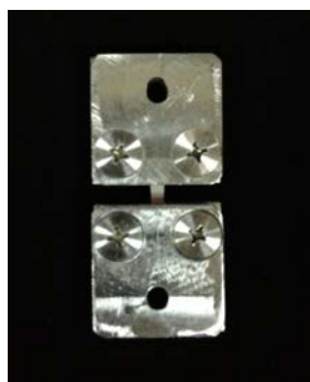
ภาพที่ 32 แสดงตัวจับยึดโลหะและขั้นตอนการยึดชิ้นงานเข้ากับตัวจับยึดโลหะ
