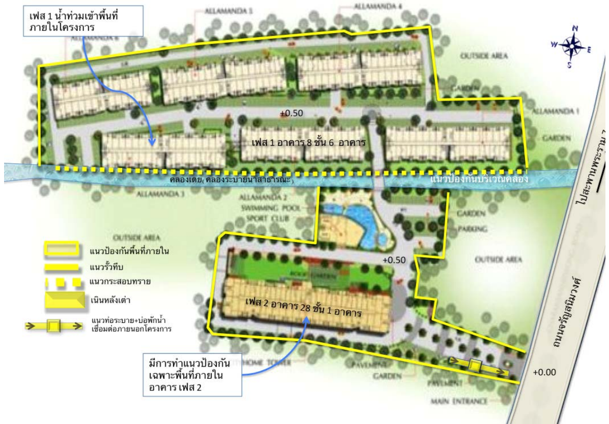
ภาพที่ 4.86 แสดงแนวกันน้ำ ผังบริเวณ โครงการซีดีโฮม รัชดา-ปิ่นเกล้า อ้างอิงระดับถนนจรัญสนิทวงศ์ +0.00 เมตร ระดับอุทกภัยสูงสุดที่ถนนจรัญสนิทวงศ์ +1.00 เมตร ระดับอุทกภัยสูงสุดภายในถนนโครงการ +0.50 เมตร
