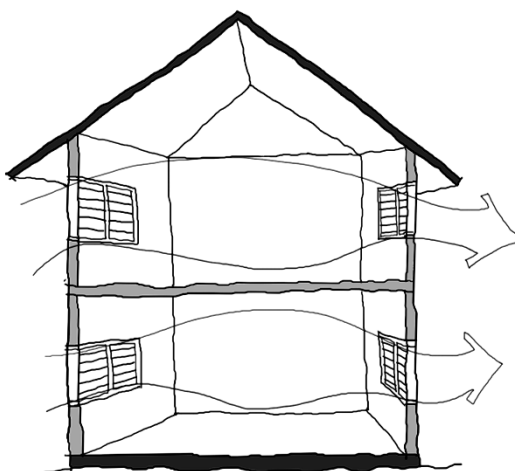
ภาพที่ 9.15 การปรับปรุงบ้านที่ใช้การระบายอากาศด้วยวิธีธรรมชาติให้น่าสบาย
