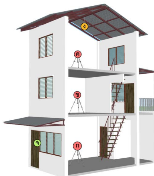
ภาพที่ 5.8 ตำแหน่งการใช้เครื่องวัดอุณหภูมิและความชื้นสัมพัทธ์ จากการจำลองด้วยโปรแกรมคอมพิวเตอร์ 3 มิติ
