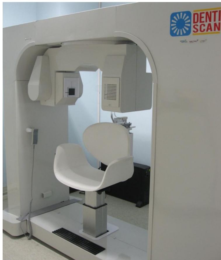
รูปที่ 3.3 เครื่องเอกซเรย์คอมพิวเตอร์ทางทันตกรรม DentiScan
