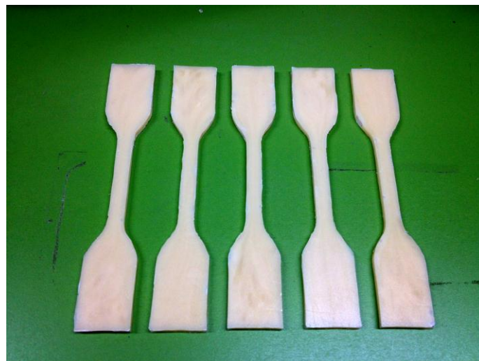
รูปที่ 3.22 ชิ้นทดสอบสำหรับทดสอบความต้านแรงดึง
