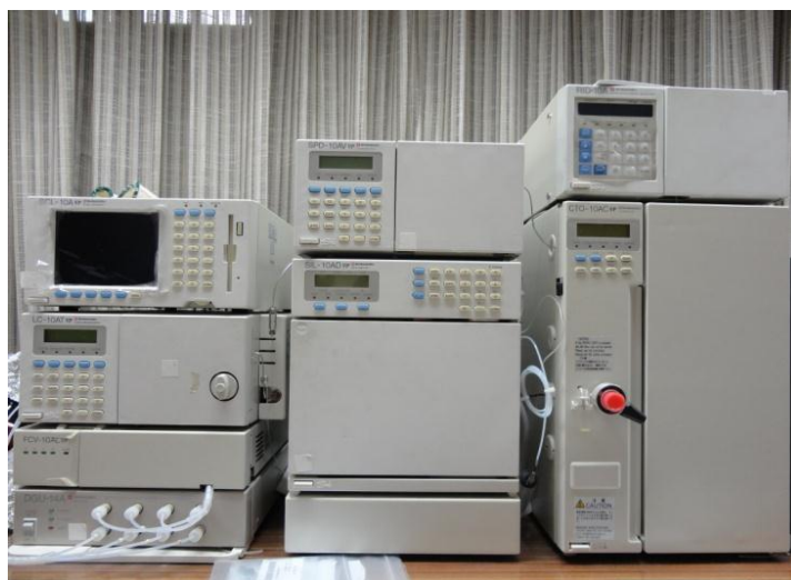
รูปที่ 3.20 เครื่องโครมาโทกราฟคอลลัมน์ชนิดเจล
