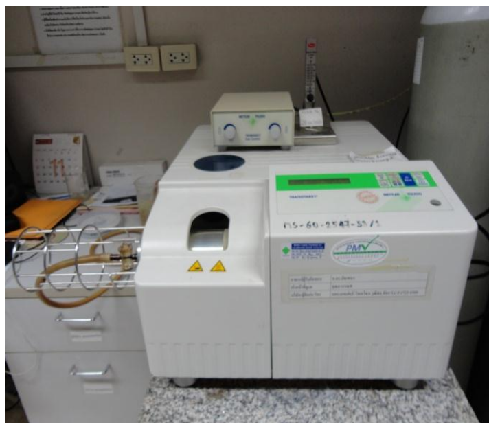
รูปที่ 3.15 เครื่องเทอร์โมกราวิเมตริกแอนาไลเซอร์
