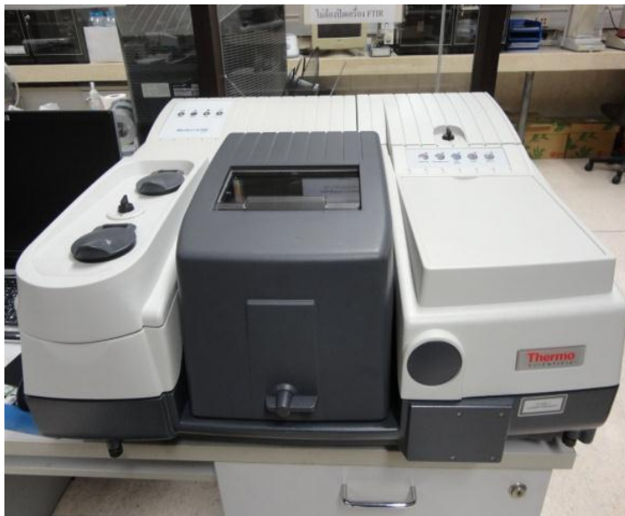
รูปที่ 3.13 เครื่องฟูเรียร์ทรานสฟอร์มอินฟราเรดสเปกโทรสโกปี
