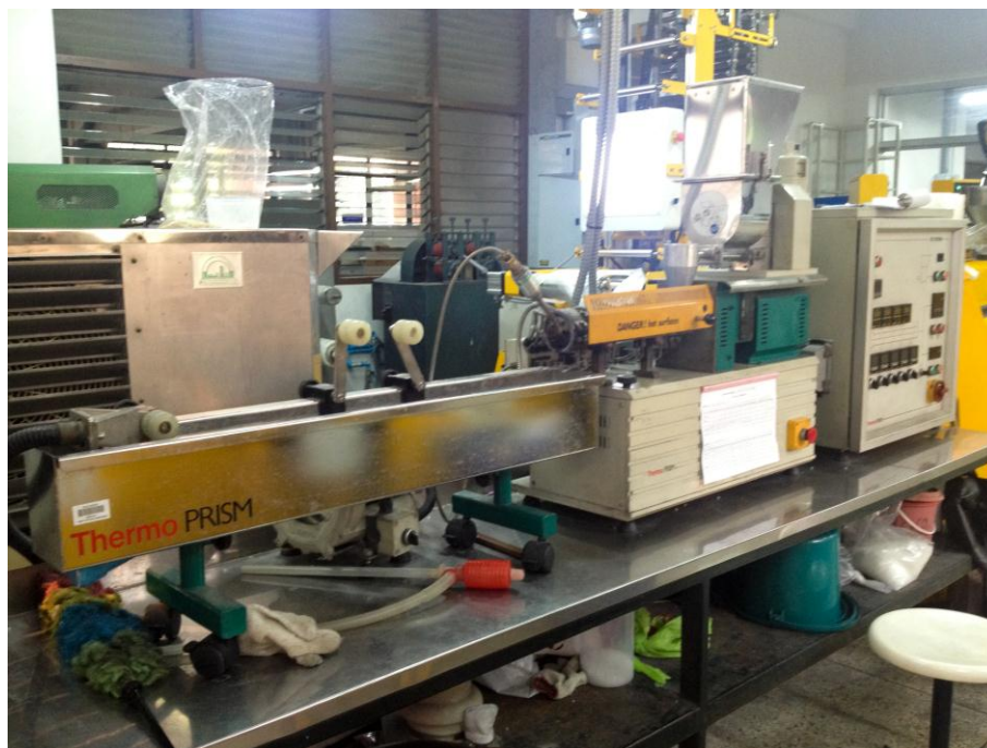
รูปที่ 3.9 เครื่องอัดรีดแบบสกรูคู่
