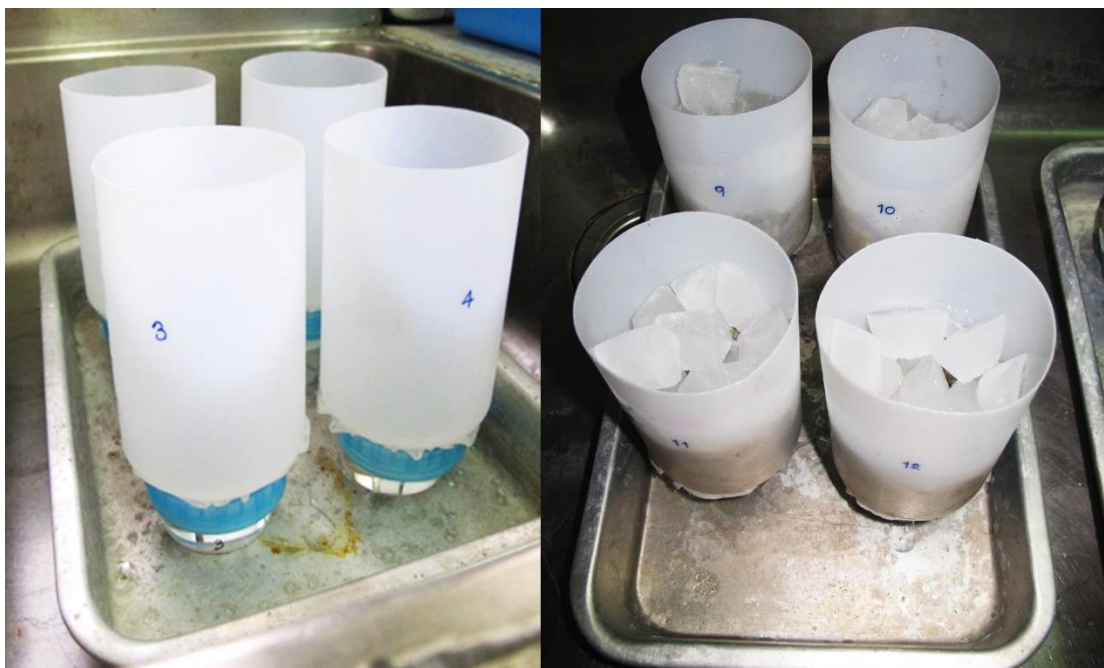
ภาพที่ 10 การเตรียมตัวอย่าง โดยการสกัดแยกซิลิเอตออกจากทรายชายฝั่งทะเลด้วยน้ำแข็งตามวิธีของ Uhlig (1964)
