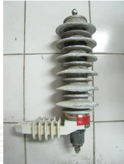
รูปที่ 3-7 กักดักเสิร์จชนิด MO สภาพเสื่อม
