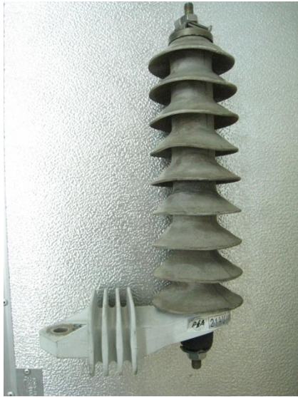
รูปที่ 3-6 กักดักเสิร์จชนิด MO สภาพดี
