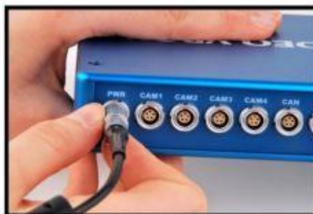
ภาพที่ 42 การต่อสายไฟเลี้ยงกับเครื่องเก็บข้อมูลการขับขี่ [27]
