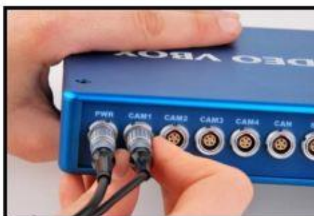
ภาพที่ 44 การต่อสายกล้องกับเครื่องบันทึกการขับขี่ [27]
