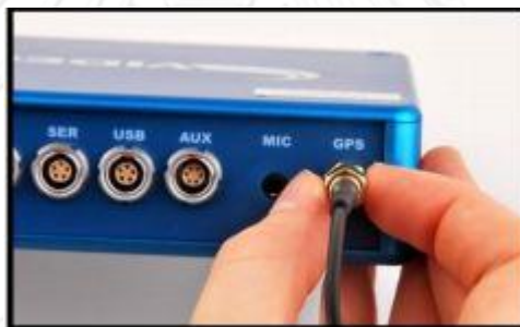
ภาพที่ 41 การต่อสายเสารับสัญญาณ [27]
