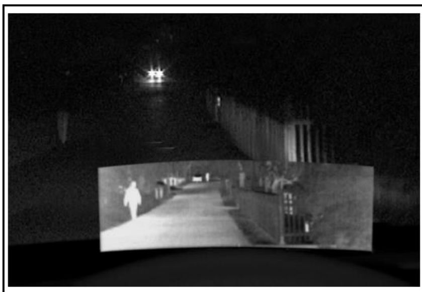
ภาพที่ 3 ระบบ Night vision จาก Volvo Safety Concept Car บริษัท Volvo [4]
