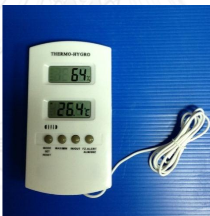
ภาพที่ 13 การตรวจอุณหภูมิอากาศและความชื้นสัมพัทธ์โดยเครื่องไฮโกรมิเตอร์
