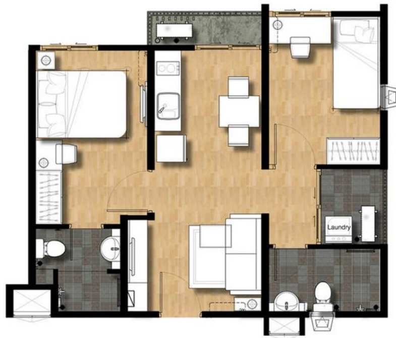
รูปภาพที่ 4- 10 ผังห้อง ขนาด 46.00 ตารางเมตร
