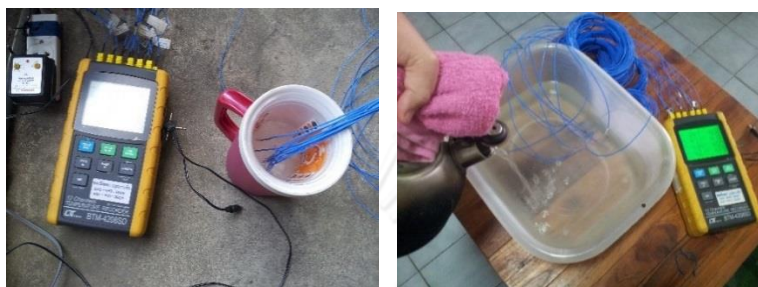
ภาพที่ 3 - 19 การนำหัววัดอุณหภูมิจุ่มลงในน้ำเย็นและน้ำร้อน
