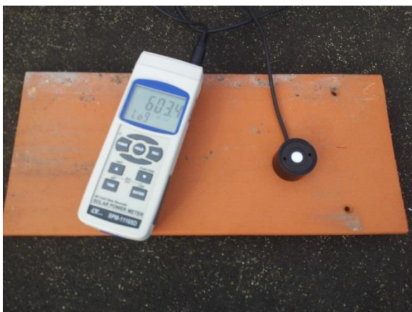
ภาพที่ 3 - 18 อุปกรณ์ Solar Power Meter
