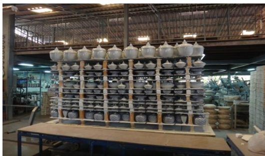
ภาพที่ 16 ขั้นตอนการเรียงของขาวก่อนนำเข้าเตาเผา
