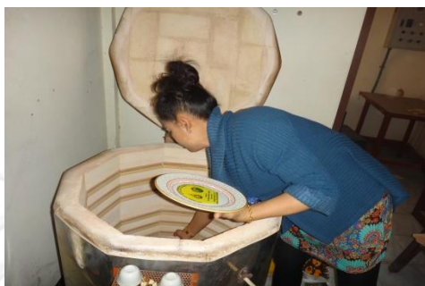
ภาพที่ 22 ขั้นตอนการจัดเรียงเพื่อนำเข้าเตาเผา
