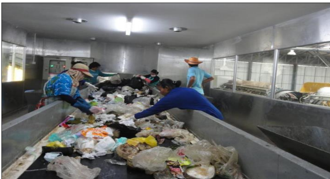
รูปที่ 4.16 ระบบคัดแยกขยะด้วยมือบนสายพานของโรงคัดแยกขยะเทศบาลนครราชสีมา[14]
