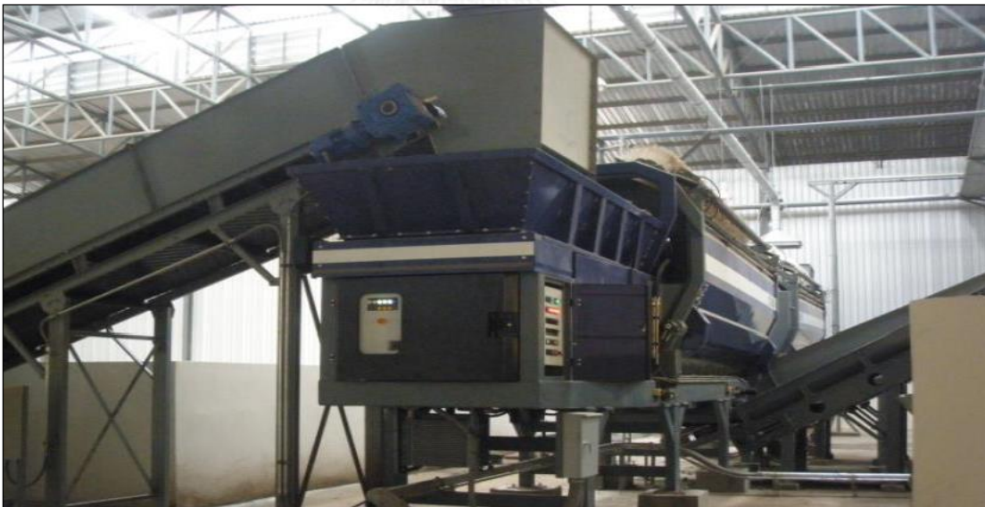
รูปที่ 4.14 เครื่องร่อนขยะแบบอูโมงของโรงคัดแยกขยะเทศบาลเมืองนครราชสีมา[14]
