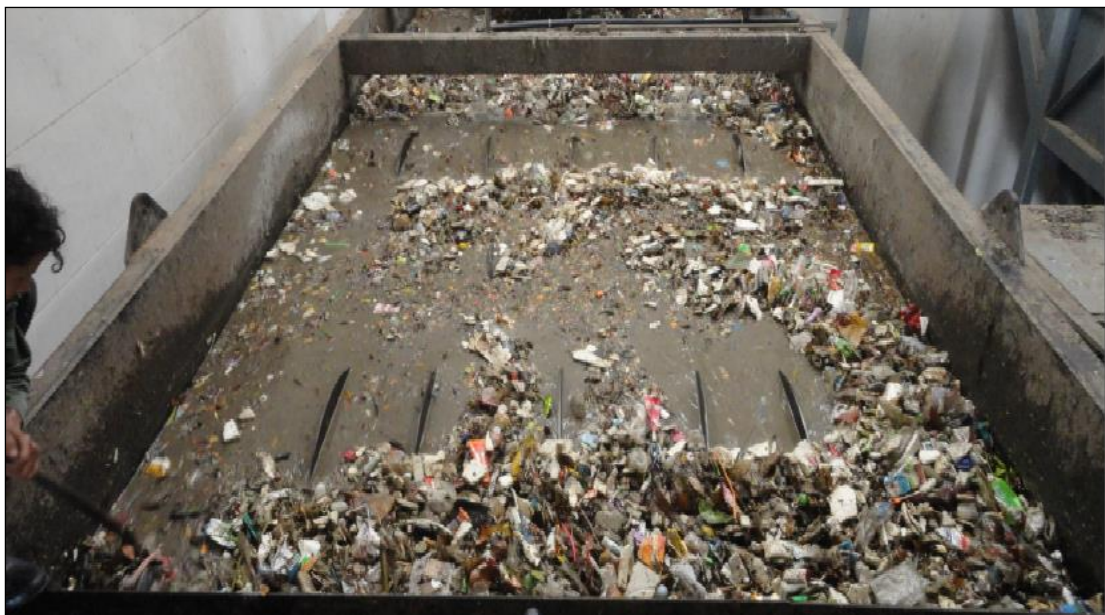
รูปที่ 4.15 เครื่องคัดแยกขยะอินทรีย์ด้วยน้ำของโรงคัดแยกขยะเทศบาลนครราชสีมา [14]
