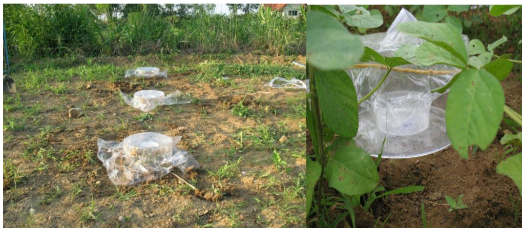
รูปที่ 3. 2 การติดตั้งกล่องเก็บตัวอย่างก๊าซคาร์บอนไดออกไซด์ลงในดินโดยวิธี Alkali absorption ในพื้นที่ทดลอง
