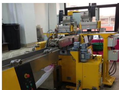
1. นำส่วนผสมที่เตรียมไว้เข้าเครื่องอัดรีด
