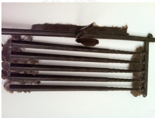
รูปที่ 26 ผลิตภัณฑ์ต้นแบบที่ขึ้นรูปด้วยอุณหภูมิปลายกระบอกฉีดสูงกว่า 150 องศาเซลเซียส
