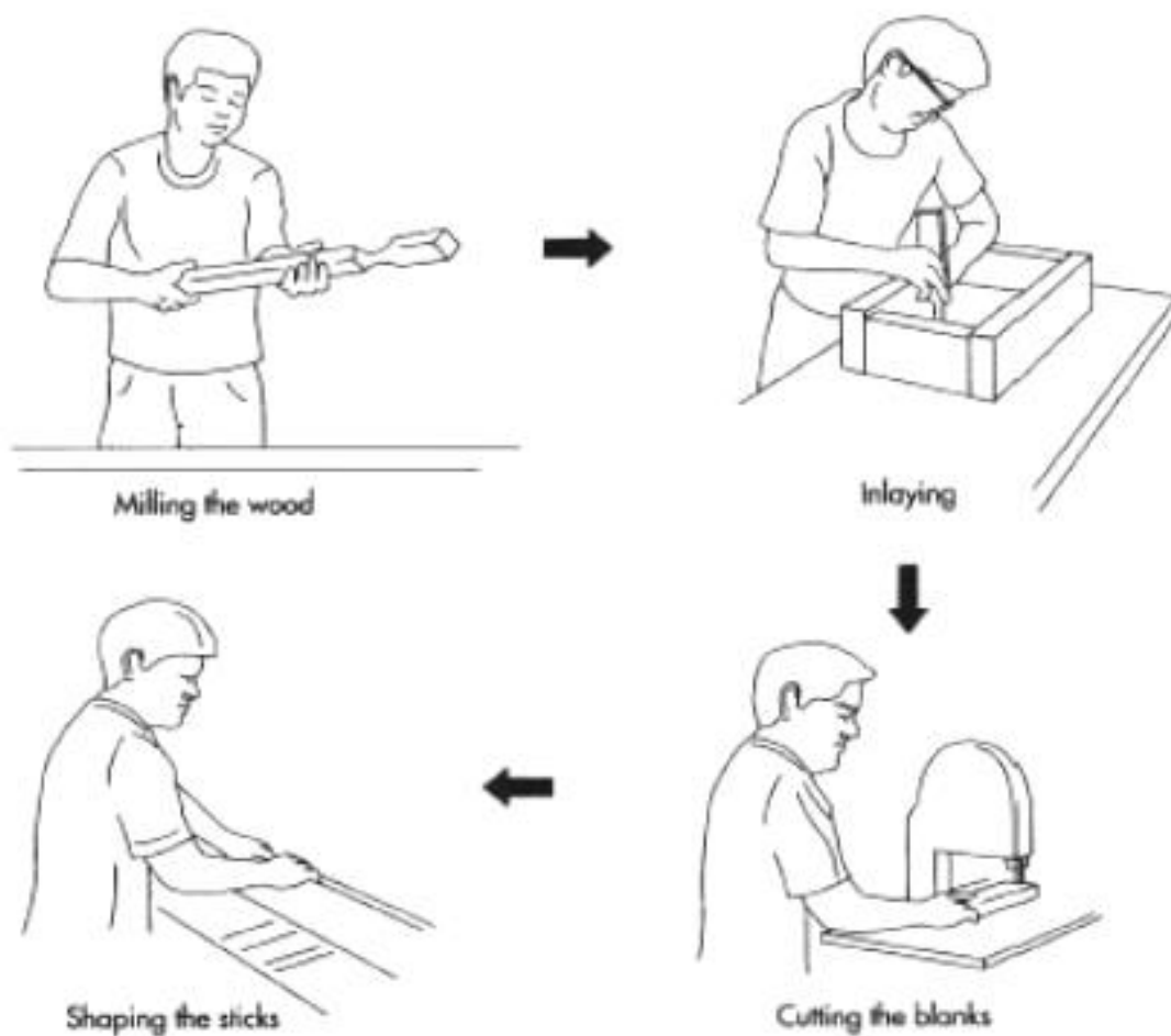
รูปที่ 9 กระบวนการผลิตตะเกียบไม้
