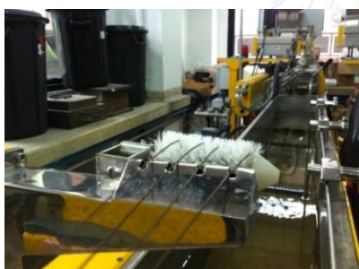
3. เส้นพลาสติกจะผ่านรางน้ำเพื่อลดอุณหภูมิ และทำให้เส้นพลาสติกแข็งตัว
