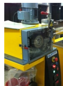
4. เส้นพลาสติกที่แข็งตัวแล้วจะถูกเข้าเครื่องตัด ให้มีลักษณะเป็นเม็ดขนาดเท่าๆ กัน
