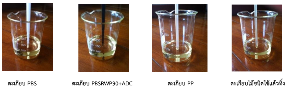
รูปที่ 35 การทดสอบความทนทานต่อไขมันในอาหาร
