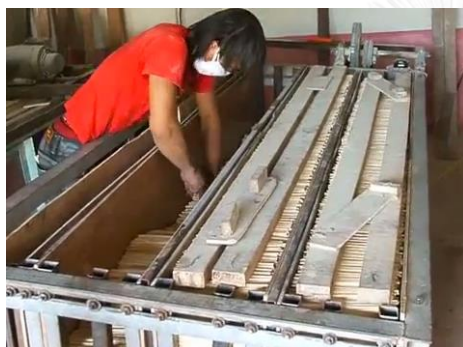
ขั้นตอนที่ 3 นำเข้าเครื่องขัดเส้นไม้
