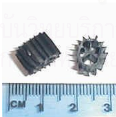
ภาพที่ 3-5 ลักษณะตัวกรองชีวภาพแบบเคลื่อนที่ (fluidized bed biofilter) (พื้นที่ผิว = 0.0009 \text{ m}^2 ต่อชิ้น และ = 864 \text{ m}^2/\text{m}^3 )
