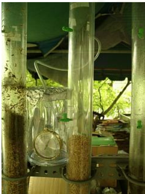
รูปที่ ๙-11 การวัดความชื้นสัมพัทธ์ของอากาศที่จุดออก
