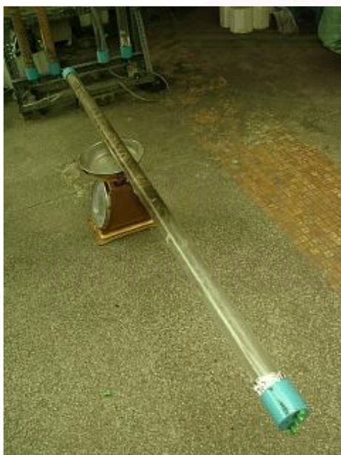
รูปที่ ๑-15 การชั่งน้ำหนักท่อ เพื่อควบคุม ความชื้นตัวกลาง
