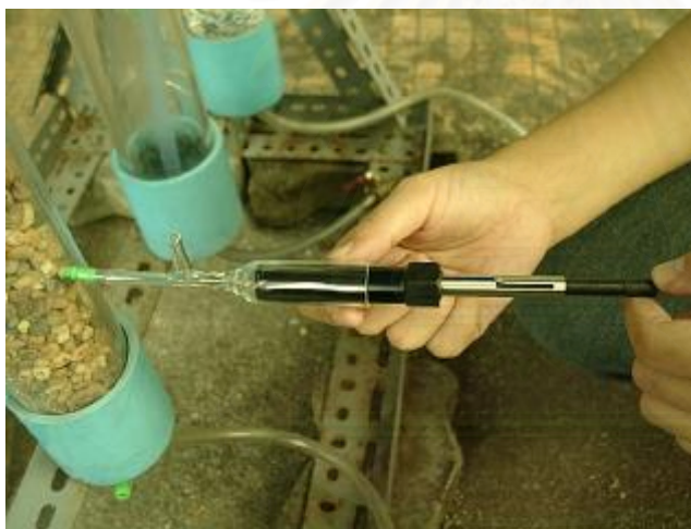
รูปที่ ฉ-18 การเก็บตัวอย่างเพื่อ วัดความเข้มข้นที่จุดเข้า
