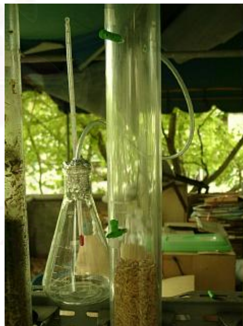
รูปที่ ๙-12 การวัดอุณหภูมิของอากาศที่จุดออก
