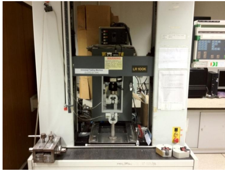
รูปที่ 3.14 เครื่องทดสอบเนกประสงคื้ห้อ LLOYD รุ่น LR 100K
