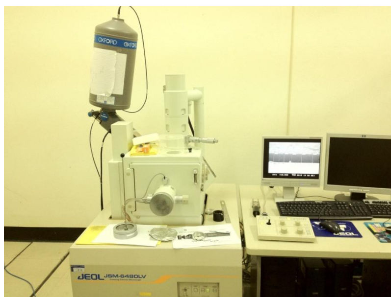
รูปที่ 3.13 กล้องจุลทรรศน์อิเล็กตรอนแบบส่องกราด ยี่ห้อ Joel
