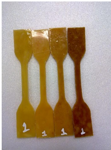
รูปที่ 3.15 ชิ้นทดสอบสำหรับทดสอบความต้านแรงดึง
