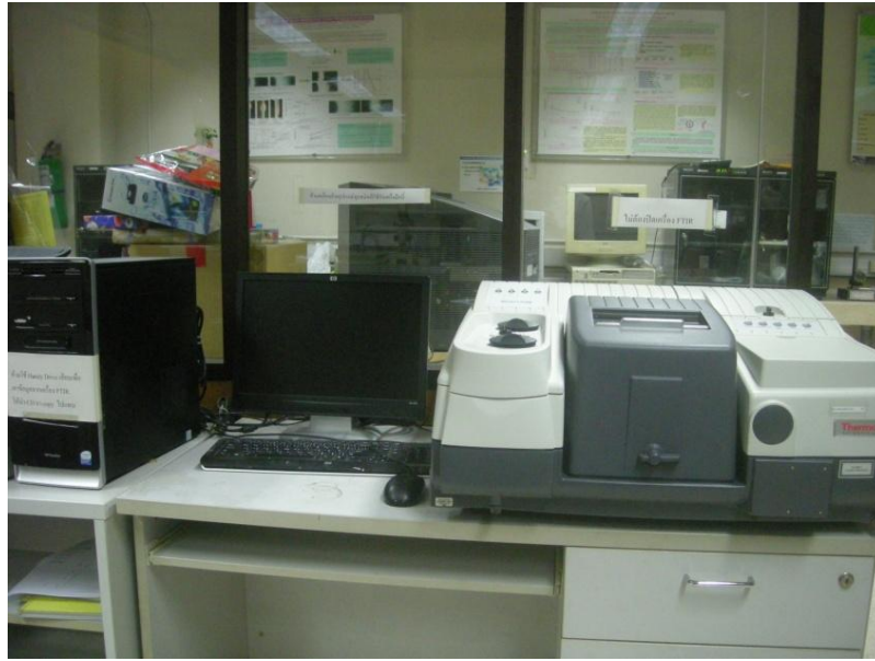
รูปที่ 3.9 เครื่องฟูเรียร์ทรานสฟอร์มสเปกโทรสโกปีชื่อ thermo sciencetific
