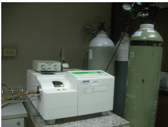
รูปที่ 3.12 เครื่องเทอร์โมกราวิเมตริกแอนาไลเซอร์ ยี่ห้อ Mettler Toledo
