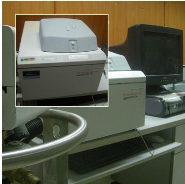
รูปที่ 3.10 เครื่องดีพีเอฟเฟอเรนเชียลสแกนนิ่งแคลอริมิเตอร์ ชื่อ Perkin Elmer
