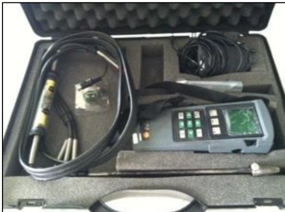
รูปที่ 3.1 เครื่องตรวจวัดองค์ประกอบของไอก๊าซเสีย (รุ่น testo 300 M and XL)
