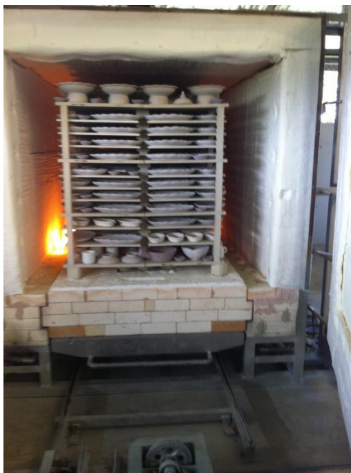
รูปที่ 3.4 เตาชุดเตาขนาด 4 ลูกบาศก์เมตรของโรงงานตัวอย่าง
