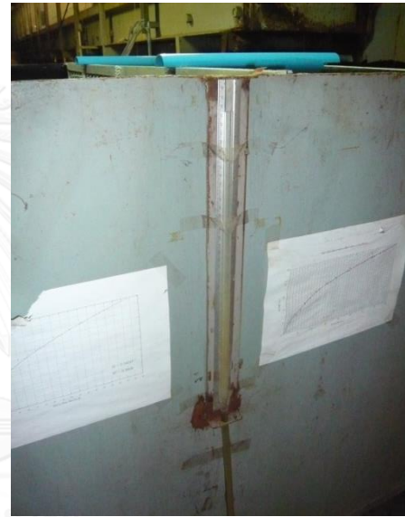
หลอดน้ำ (manometer) ด้านนอกถังฝาย
