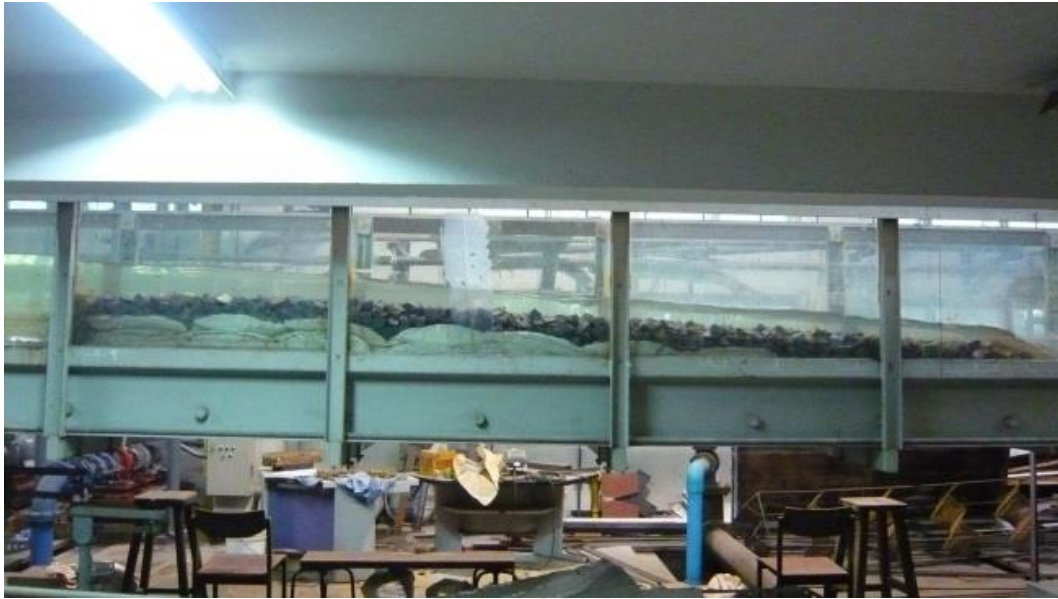
รูปที่ 3-4 ตัวอย่างการติดตั้งแบบจำลองจริงที่ลาดท้องน้ำ 5%
