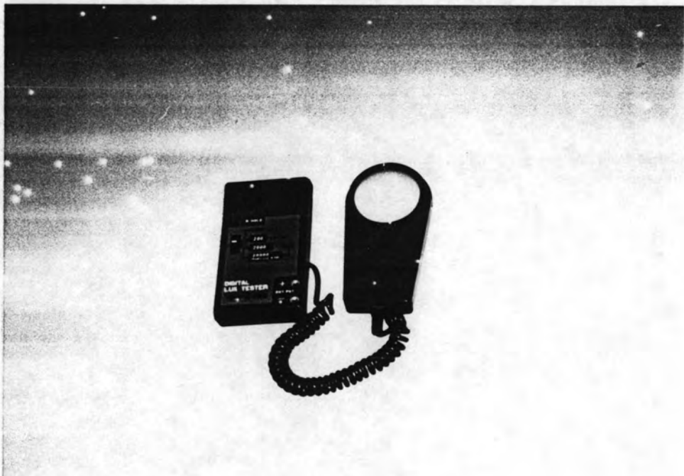
รูปที่ ข.7 เครื่องมือวัดความส่องสว่าง (Lux-meter)
